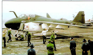
Niektóre samoloty z lotniskowców nosiły doświadczalny ciemnozielony kamuflaż, który jednak się nie przyjął. Ten A-6 ma końcówkę do tankowania w powietrzu.
