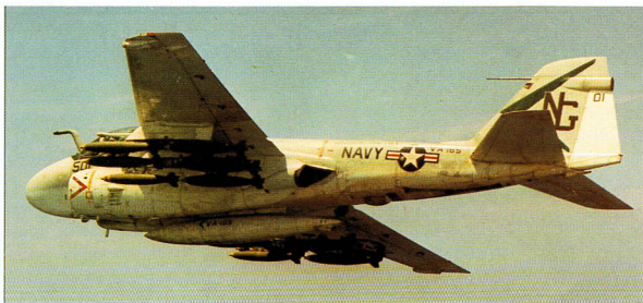
Ten VA-65 A-6 Intruder ma uchwyt do mocowania bomb pod skrzydłami. W krótszych misjach zamiast zbiornika w centralnej części kadłuba zabierał dodatkowe bomby.
