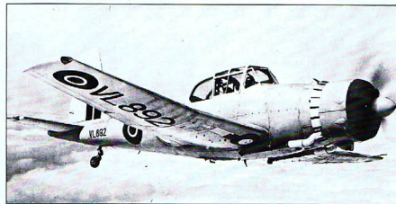
W związku z tym, że przewidziano do napędu silnik turbosmigłowy Armstrong Siddeley Mamba nie był jeszcze gotowy, prototyp Boulton Paul P-108 Balliol latał początkowo z gwiazdowym silnikiem Bristol Mercury. Samoloty serii produkcyjnej napędzane były sprawdzonym silnikiem Merlin.
