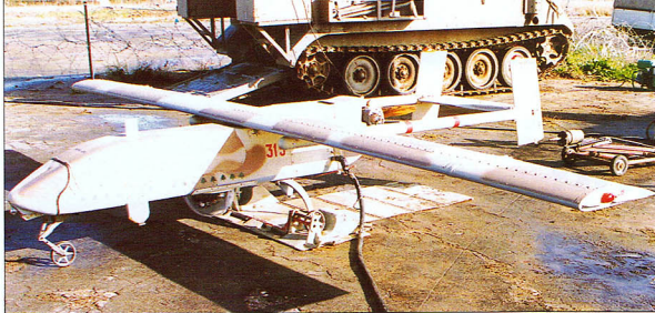
Samoloty RVP uczestniczyły we wszystkich walkach o Dolinę Bekaa, zarówno jako cel-pułapka, jak i w misjach rozpoznawczych. Na zdjęciu samolot IAI Scout, wyposażony w kamerę telewizyjną w szklanej kapturce i inny osprzęt rozpoznawczy. Drzewa cedrowe na burcie symbolizują 14 zwycięskich lotów nad Libanem.
