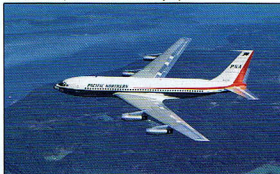
N720W był drugim z dwóch samolotów Boeing 720 dostarczonych do Pacific Northern. Później latały one w barwach Western Airlines, by w maju 1973 r. trafić do Alaska Airlines. Smukłe gondole silników świadczą o stosowaniu wczesnej wersji silników JT3C.
