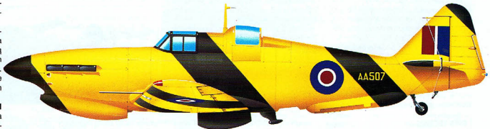
Boulton Paul Defiant TT Mk I z myśliwskiej jednostki treningowej RAF, bazującej w 1945 r. na Środkowym Wschodzie. Żółto-czarne pasy pomagały w wyróżnieniu maszyny, kiedy służyła jako holownik celów.
