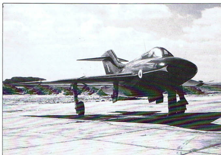
P-120 podobny do P-111 był wyposażony w usterzenie w kształcie litery T. Flatter pływowego usterzenia poziomego był prawdopodobną przyczyną utraty samolotu w 1952 r.
