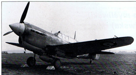
Kittyhawk Mk IA RAF, rozpoznawalny po sześciu karabinach maszynowych w skrzydłach i silniku Allison (zwracają uwagę rury wdechowe zebrane w pary). Choć to zdjęcie wykonano w Wielkiej Brytanii w kwietniu 1942 r., większość kittyhawków RAF służyła na Środkowym Wschodzie.
