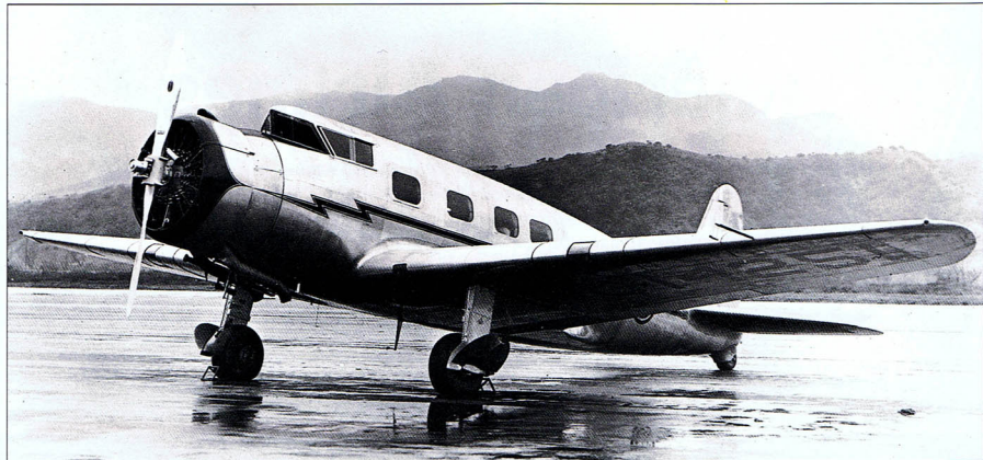
U góry: Vultee V-1A napędzany gwiazdowym silnikiem Wright Cyclone, przewoził w swym kadłubie o modernistycznym kształcie ośmiu pasażerów. Ten typ samolotu był używany przez American Airlines na szybkich trasach krótkiego zasięgu.
