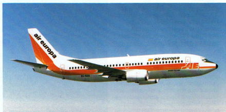
Boeing 737 drugiej generacji nabrał lepszych proporcji przez zabudowę turboventylatorowych silników CFM56 oraz płytki w nasady statecznika pionowego.
