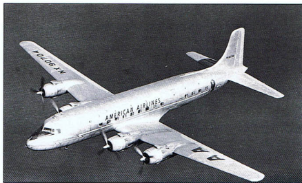
American były pierwszym użytkownikiem Douglasa DC-6, wykorzystując tę rozwojową wersję DC-4 z ciśnieniową kabiną na bardzo obciążonych trasach krajowych, m.in. Nowy Jork–Los Angeles.
