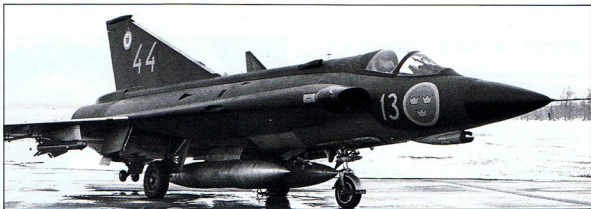
Lącznie 64 samoloty J35F zostały zmodyfikowane i zmorderzowane do standardu J35J (Johan) na potrzeby lotnictwa Szwecji. Ich najbardziej widoczną cechą jest dodanie węzłów podwieszania uzbrojenia pod wewnętrzną częścią skrzydła.
