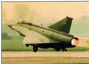
SAAB J35F Duńskich Sił Powietrznych grzmi pełnym ciągiem licencyjnego silnika odrzutowego Rolls-Royce Avon 300 z włączonym dopalaczem ypp 67. W służbie Danii ta wersja drakena miała 11 węzłów do podwiezania uzbrojenia.
