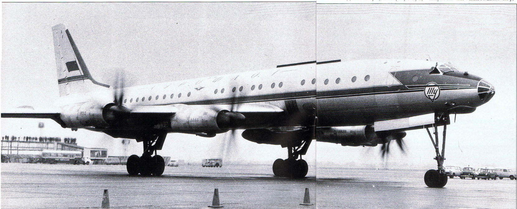
Trzydzieści dwie łopaty śmigieł, napędzane czterema najpotężniejszymi silnikami turbosmigłowymi na świecie, stanowiły imponującą i charakterystyczną wizytówkę Tu-114. Na zdjęciu widzimy prototyp przybyły na wystawę lotniczą w 1959 r., po wylądowaniu na lotnisku Le Bourget w Paryżu.
