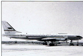
Tu-114 miał te same skrzydła co „Bear”, lecz zamontowane nisko w kadłubie, tak że konstrukcja nośna skrzydła nie zajmowała miejsca wewnątrz kabiny linowca.
