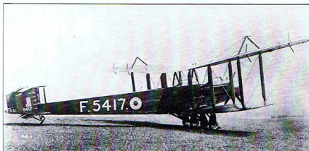
F5417 był jednym ze standardowych O/400 z silnikami Eagle VIII, wytwarzanych przez National Aircraft Factory nr 1 w Waddon (Croydon). Produkcję prowadził Cubbits, montując bombowce z części dostarczanych przez setki firm meblarskich i budowlanych z rejonu Londynu. Samolot ze zdjęcia ma niestandardowe oznakowanie – czerwono-niebieski wyplywek ogona typu B i osioblwe kółko na burcie.
