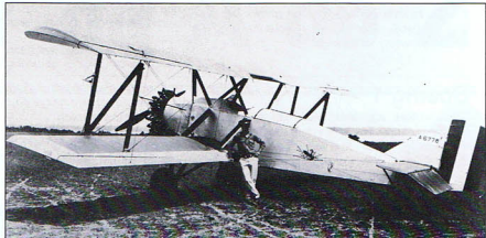
Treningowy Boeing Model 21, zakupiony przez amerykańską marynarkę wojenną zyskał oznaczenie NB-1. W latach 1924-25 dostarczono około 41 tych samolotów. Na ilustracji widać egzemplarz z końcówki produkcji, z silnikiem Wright J-5. Samoloty te wyposażone były przez korpusy marynarki w aparaty opryskową do zwalczania komarów w tropikach.
