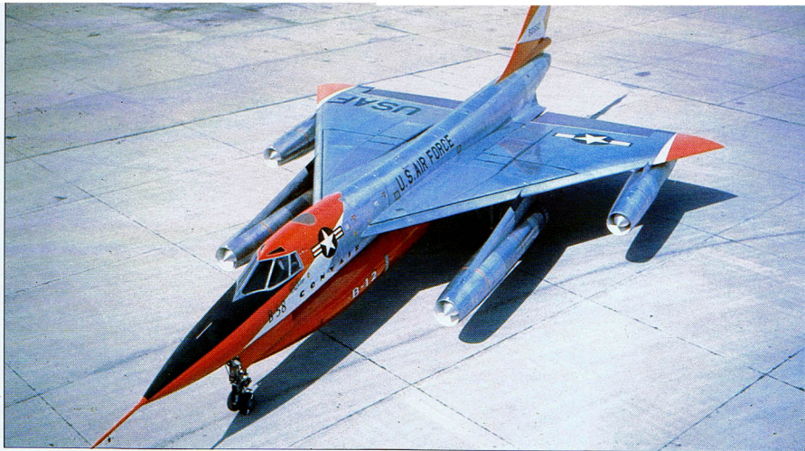
Ta fotografia została prawdopodobnie wykonana w końcu 1957 r., podczas inauguracyjnych lotów próbnych pierwszego jedynokomponentowego zasobnika na samolocie 55-0662. Tak jak pierwsza z 30 maszyn testowych, ten egzemplarz posiada również niestandardowe czerwono-białe malowanie. Egzemplarze produkcyjne były bezbarwne, z wyjątkiem czarnej powierzchni przeciwośliskowej.
