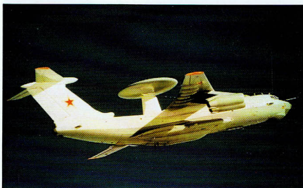
Mainstay pozostaje obecnie w pełnej gotowości operacyjnej, a ten egzemplarz zaobserwowały Królewskie Siły Powietrzne Norwegii. Czas przebywania samolotu w powietrzu można znacznie wydłużyć, dzięki możliwości tankowania w locie. Zbudowana na bazie Il-76 latająca cysterna zyskała w nomenklaturze NATO nazwę Midas.
