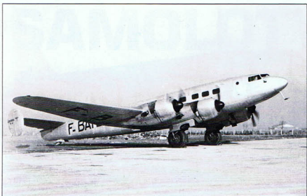
Po II wojnie światowej konstrukcja M.B.161 została zweryfikowana w celu podjęcia produkcji samolotu pasażerskiego Sud Est SE 161 Langueoed – jednej z kilku podobnych wersji.
