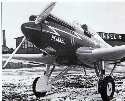
Wyżej: Zbliżenie dzioba He 70 ukazuje starannie oprofilowane osłony silnika i czystą zabudowę chłodnicy. Można także zauważyć nieco ujemny wznios nasady skrzydła, dający konfigurację skrzydła w układzie „M”.
