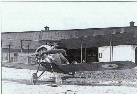
Ostateczna postać produkcyjnej wersji Snipe'a miała wyważone lotki i klasyczny kształt statecznika pionowego Sopwitha. Ten samolot latał w ramach 70 Eskadry, a charakterystyczna pasiasta otosna silnika oznacza zmianę „B” w tej jednostce.
