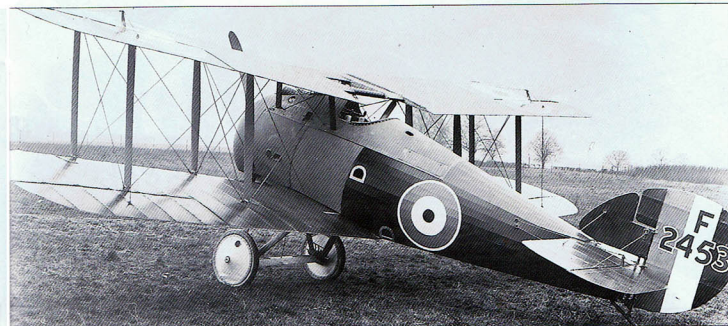
Snipe'y zostały uzbrojone w dwa synchronizowane karabiny maszynowe Vickers kalibru 7,7 mm, częściowo ukryte w przedniej części kadłuba. Samolot był przystosowany do przenoszenia lekkich bomb pod skrzydłami i czasem wykorzystywano tę możliwość podczas zadań patrolowych na Środkowym Wschodzie.
