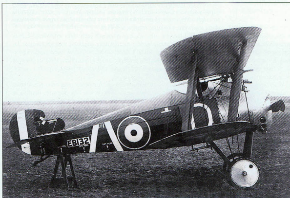
Trzecią formacją wyposażoną w Snipe'y była 208 Eskadra, która znakomicie wykorzystywała tę maszynę w ostatnich dniach wojny i w Armii Okupacyjnej. Samolot ma oryginalne, nie wyważone lotki, a także nietypowy układ statecznika pionowego i steru kierunku.
