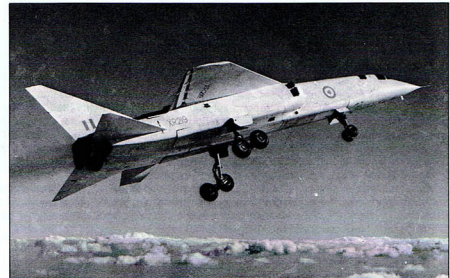
Pierwszym lotem dokonywanym w wyszczuplonym podwoziem, tak jak na tym zdjęciu. Widak klapy wychylone na 35°, lecz oczywiście z nieczynnym nadmuchem. Dodatkowe chwytaki powietrza za wlotami pozostały otwarte, dostarczając większej ilości powietrza koniecznego do prawidłowego spalania paliwa przy wysokiej mocy. Są one źródłem sporego oporu aerodynamicznego, dlatego na większości zakresu prędkości lotu są zamknięte.
