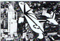
Odpowiednikiem stosowanego w US Navy samolotu P-12C był F4B-2. Ten latający w jednostkach US Army miał oznaczenie firmowe – Boeing 223. Różnił się od lądowego F4B-1 tylko drobnymi szczegółami. Egzemplarz ze zdjęcia należał do VF-6B szwadronu, stacjonującego na pokładzie USS Saratoga. Później wszystkie F4B-2 zostały zmodyfikowane przez zabudowanie usterzenia zaprojektowanego dla F4B-4.
