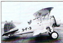
Odpowiednikiem stosowanego w US Navy samolotu P-12C był F4B-2. Ten latający w jednostkach US Army miał oznaczenie firmowe – Boeing 223. Różnił się od lądowego F4B-1 tylko drobnymi szczegółami. Egzemplarz ze zdjęcia należał do VF-6B szwadronu, stacjonującego na pokładzie USS Saratoga. Później wszystkie F4B-2 zostały zmodyfikowane przez zabudowanie usterzenia zaprojektowanego dla F4B-4.
