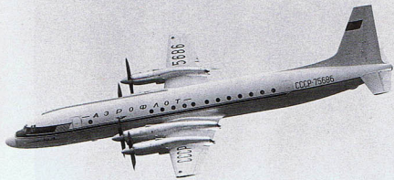
Il-18 Aeroflotu podczas lotu próbnego: pokaz zwinnosci i wyrazistosci kształtu. Który stał się charakterystyczny dla tego samolotu. Potężne silniki turbodruzelowe zwiększały siłę ciągu uzyskiwaną ze śmigieł. W 1959 r. wersja ta pobiła wiele rekordów w klasie maszyn turbosmiglowych.
