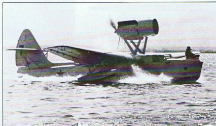
Łódź latająca krótkiego zasięgu – Berijew MBR-2 miała swój rzędowy silnik napędzający pchające śmigło, zamontowany na wspornikach nad skrzydłem. Przed silnikiem umieszczona była duża owalna chłodnica cieczy chłodzącej silnik.
