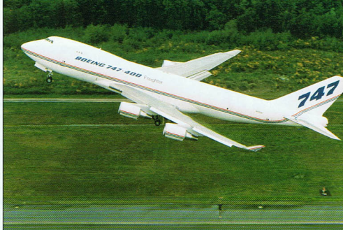
Wersja 747-400F łączy kadłub od Boeinga 200F oraz wzmocnione skrzydła o powiększonej rozpiętości z wersji 400. Na zdjęciu prototyp (N6005C) podczas pierwszego lotu 7 maja 1993 r. Do połowy 1998 r. Boeing sprzedał w sumie 20 maszyn wersji 747-400F.
