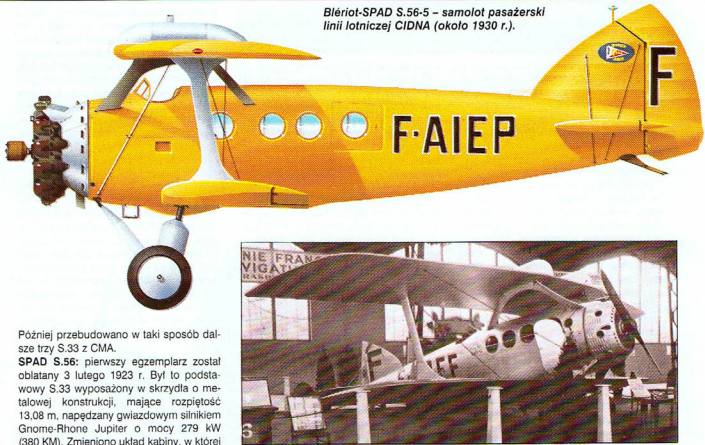
Samolot transportowy Blériot-SPAD S.33. Typowa konstrukcja Herbemontéa ze skośnym górnym skrzydłem, prostym skrzydłem dolnym o mniejszej rozpiętości i prostym wspornikiem w komorze skrzydeł. S.33 posiadał miejsca dla czterech pasażerów. Na owiewce wlotu chłodzonego cieczy silnika Salmson widoczna jest duża liczba żeberków zwiększających intensywność i równomierność chłodzenia.
