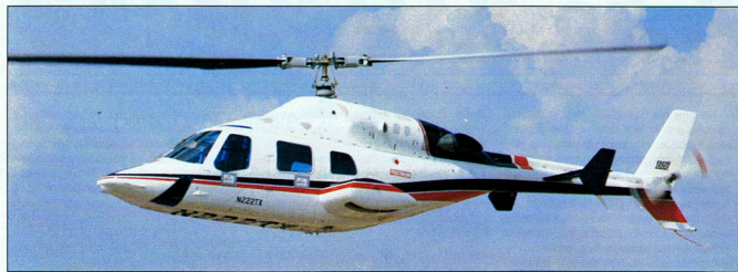
Elegancki śmigłowiec Bell 222 został zaprojektowany dla ośmiu osób, włączając w to i pilota. Wersja 222 Executive mieści siedem osób, a 222 Offshore przystosowany jest do lotów z dwoma pilotami i pięcioma pasażerami.
