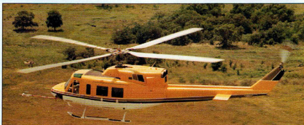
Pozbawiona tradycyjnego dwułopatowego wirnika wersja Bell 412, bazująca na Bell 212, ma wirnik nośny z czterema łopatami.
