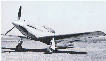
Pierwszy z wielu. Prototyp N.A. 73X o aerodynamicznie dopracowanej sylwetce sfotografowany zaraz po zbudowaniu silnika Allison. Z czasem samolot otrzymał cywilną rejestrację NX19998, a ogon został pomalowany w pasy wg oznaczeń wojskowych.
