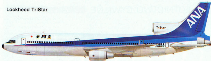
Lockheed L-1011 wersja 3B5 TriStar krajowego przewoźnika japońskiego, All Nippon Airways. Patrząc z zewnątrz nie można odróżnić wersji L-1011-1, -50 i -100 TriStar. Podstawowe modyfikacje obejmują typ silnika, opony, obcięcie kół i hydraulikę i wewnętrzne zbiorniki paliwa.
