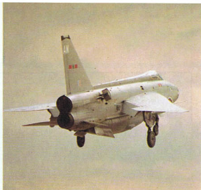
Na kilku BAC Lightningach z Dywizjonu 5 RAF namalowano paszczę rekina podczas ćwiczeń bojowych na Cyprze. Na zdjęciu F.Mk 6 podchodzi do lądowania w Binbrook, pokazując maksymalnie wychylone kłapy skrzydłowe i hamulce aerodynamiczne na kadłubie.
