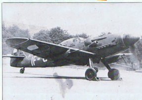
Po upadku Niemiec Messerschmitt Bf 109 kontynuował służbę w wielu krajach Europy Wschodniej. Kiedy skończyły się silniki, próbowano je kilkakrotnie wymienić. Jedną z takich prób był samolot Avia S.199 z silnikiem Jumo 211F, używany przez Czechosłowację i Izrael.
