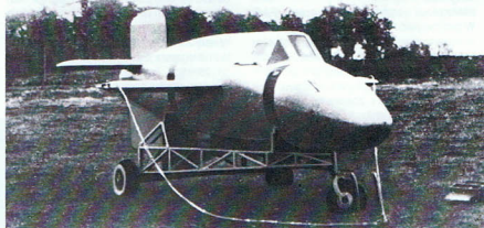
Fortel zrodzony w rezultacie beznadziejnej sytuacji Niemiec w 1944 r. – Bachem Ba 349 Natter. Pełnił rolę samolotu przechwytyjącego, którego fragmenty były przeznaczone do jednorazowego użycia.
