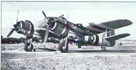
Beaufighter Mk X (NE798) należący do 455. Dywizjonu Royal Australian Air Force stacjonujący we wschodniej Anglii i wykonujący ataki szturmowe przeciwko żegludze nieprzyjaciela. Widoczne pasy inwazyjne oraz dwie bomby 227 kg podczepione pod kadłubem oraz sześć pasy inwazyjne oraz dwie bomby 113 kg pod skrzydłami.
