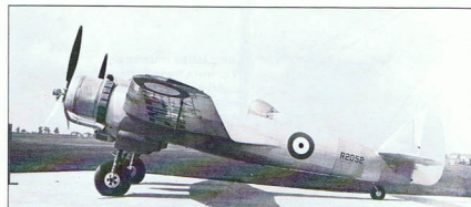
Pierwszy prototyp samolotu Bristol typ 156 Beaufighter (R2052) na lotnisku Filton w lipcu 1939 r. Jest napędzany silnikami Hercules I i nie posiada jeszcze uzbrojenia. Skrzydła zewnętrzne, sterulca i podwozie pochodzą z Beauforta, ale w czasie produkcji zostały one znacznie zmienione.
