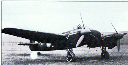
R2274 był eksperymentalnym Beaufighters Mk V, jedną z pierwszych seryjnych maszyn typu Mk II napędzanych silnikami Merlin. Potem został zmodyfikowany przez dodanie elektrycznie napędzanej wieżyczki strzeleckiej umieszczonej tuż za kabiną pilota. Samolot na stałe wyposażono w radar.
