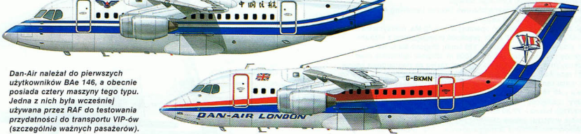
10 maszyn zamówionych przez Zarząd Lotnictwa Cywilnego Chin (Civil Aviation Administration of China CAAC) należy do serii BAe 146-100. W odróżnieniu od serii 200, ten wariant ma możliwość operowania z lotnisk o nieutwardzonej nawierzchni.
