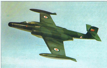
Avro Canada CF-100 Mk 4A w barwach Royal Canadian Air Force. W formacji tej samoloty te służyły przez 30 lat operując w każdych warunkach atmosferycznych jako samoloty przechwytyjące, latające na duże odległości.
