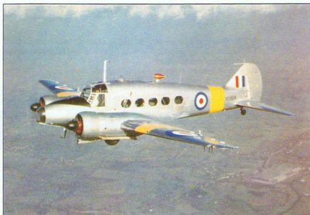
Anson T.20 przewidziany był w projekcie do treningu nawigacyjnego i bombardierskiego w Rodzaji. Posiadał przeszklenia nos i celownikiem bombardierskim i wyrzutnik bomb pod kadłubem i skrzydłami.
