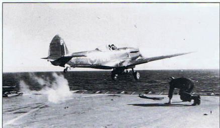
Seafire Mk 17 startuje z pokładu lotniskowca Triumph. Osłona kabiny w kształcie leżki dawała pilotowi o wiele lepszą widoczność.
