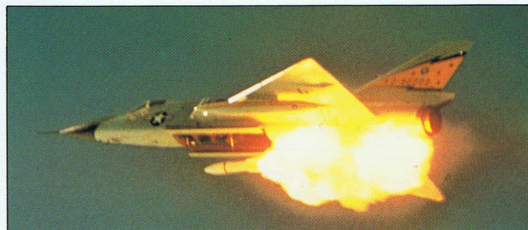
Delta Dart odpala przenoszony w tylnej części luku uzbrojenia pocisk AIR-2A Genie.
