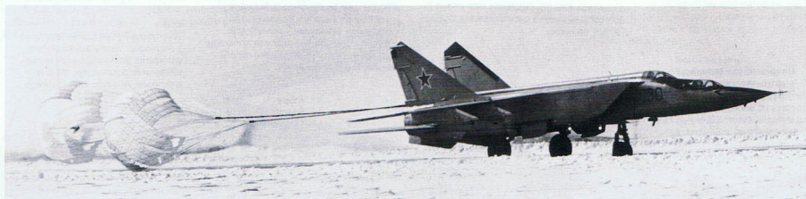
MiG-25 ma masę do lądowania tak dużą, że potrzebne są dwa spadochrony hamujące dobieg. Samoloty seryjne wyposażano w spadochrony stożkowe o powierzchni 60 m 2 lub spadochrony krzyżowe o powierzchni 50 m 2 . Te ostatnie widać za samolotem MiG-25PU powracającym z zadania treningowego.
