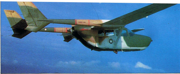
Samolot Cessna O-2B nie wypełniał zadań WKL, lecz również służył w Wietnamie z 9. Dywizjonem Operacji Specjalnych w Nha Trang. Samoloty te były wyposażone w głośniki i wyrzutnie ulotek do zadań wojny psychologicznej.
