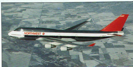
Aby 747 mógł sprostać nowym technologiom, Boeing zaprojektował 747-400 ze skrzydłami o większej rozpiętości (i wingletami), większym zasięgiem, nowoczesnym wyposażeniem i dwuosobową kabiną załogi. Linia Northwest jako pierwsze wprowadziła tę wersję do eksploatacji.
