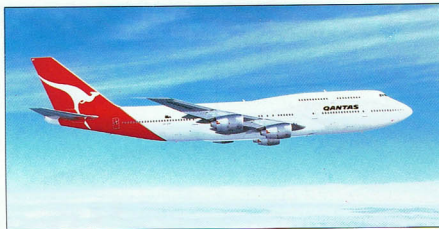
747-300 (wcześniej 747 SUD) dysponujący wydłużonym pokładem górnym. Dzięki temu zwiększyła się nie tylko liczba miejsc, lecz również polepszona została jego aerodynamika, co spowodowało wzrost prędkości podróży samolotu.
