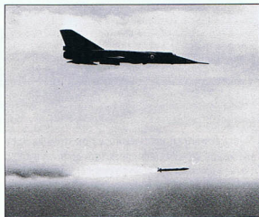
Doświadczalny pocisk ASMP oddziela się od Mirage IVP Nr 1. ASMP jest napędzany silnikiem strumieniowym na paliwo ciekłe i raketowym silnikiem przyspieszającym na paliwo stałe. Ma on zasięg od 80 km (2 Ma na poziomie morza) do 300 km (3 Ma na dużej wysokości).
