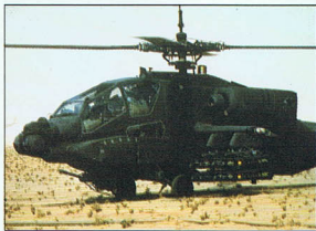
Powyżej: Budzący trwogę Apache atakował irackie czołgi, bunkry i pojazdy naprowadzającymi laserowo pociskami Hellfire. Maksymalny ładunek tej maszyny wynosił 16 pocisków.
