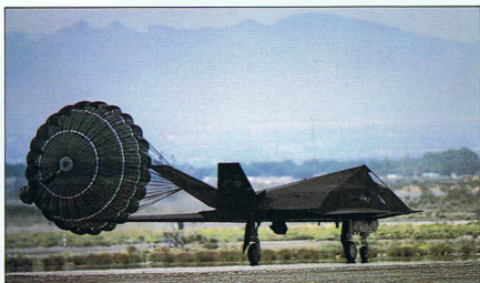
F-117A odznacza się bardzo dużą prędkością przyziemienia i dlatego za każdym razem stosowany jest spadochron hamujący dla skrócenia dobiegu. Spadochron zabudowany jest w zasobniku między statecznikami.
