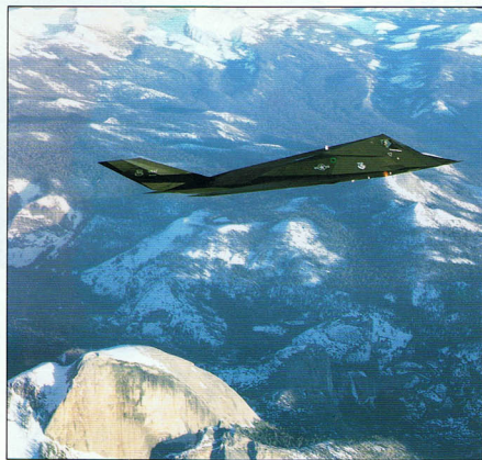
F-117A w locie nad Half Dome w Yosemite Valley. W czasie pokoju samoloty noszą pełne oznaczenie oraz błyskowe światła nawigacyjne o dużej widzialności oraz reflektory radarowe. W okresie napięć oraz na samolotach Sił Specjalnych są one usuwane.
