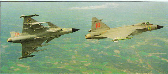
Gripeny JAS 39 wyposażone w pociski AMRAAM, to klasyczni przedstawiciele dzisiejszej floty bojowej Szwecji. W odróżnieniu od JAS-ów 39B seryjne JAS-y 39A mają czarne malowanie dziobu z anteną radiolokatora.
