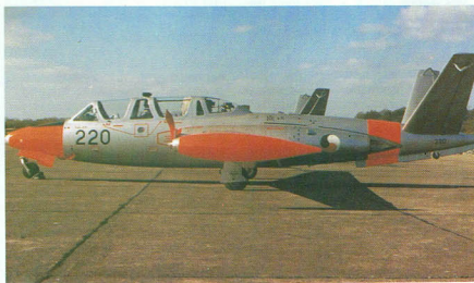
Kilka Super Magister wyposażonych w karabiny maszynowe kal. 7,62 mm i rakiety stanowi główną siłę Irish Air Corps. Używane w większości przypadków do szkoleń, irlandzkie samoloty Magister wyposażone były w potężniejsze silniki Marbore VI.
