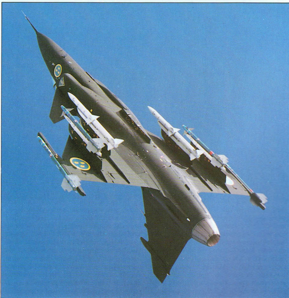
Prototyp Gripena numer 39-2 pomalowano w 1995 roku na czarno. Po testach na opadanie w korkociągu i innych figurach akrobacyjnych z dużym kątem wchodzenia, boczne stateczniki samolotu malowano w białe pasy; wyposażony został również w spadochron hamujący na wypadek konieczności wyprawienia z korkociągu.
