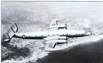
Zamontowanie silników turbosmigłowych na Constellation było naturalną kolejną rzeczą, ale otrzymano tylko nieliczne Pratt & Whitney T34. Cztery samoloty zostały dostarczone do US Navy jako RV-2 (oznaczenie firmowe L-1249) do szybkiego transportu, a dwa pod oznaczeniem YC-121F zostały przekazane do prób w USAF.
