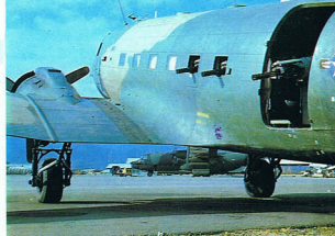
Trzy karabiny maszynowe na burcie AC-47D „Spooky”; każde z nich mogło wystrzelić 6000 jednostek ognia na minutę. Z tyłu widać „Combat Talon” C-130E [Pazur Bojowy], używany w tajnych operacjach Sił Specjalnych.
