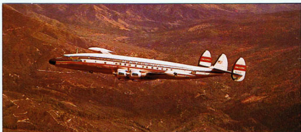
Ostatnim wariantem Super Constellation był L-1049H, który cechował się możliwościami wersji mieszanej pasażersko-towarowej. Jedną z jego z podstawowych cech była możliwość szybkiej zmiany wnętrza.
