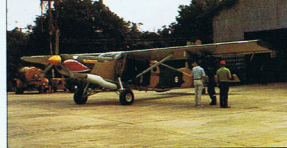
Jeden ze współzawodników w projekcie „Credible Chase”, pokazany w trakcie oceny w Tajlandii. Jest to Fairchild AU-23A Peacemaker w komplecie z działkami XM197 kalibru 20 mm o trzech lufach, montowanym w kabine.
