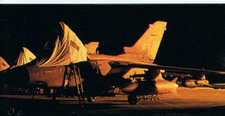
ZD 845 „Angel Face” (Oblicze Anioła) odpoczywa pomiędzy misjami w Tabuk. Płachta białego musliu chroni przrządy kokpitu przed upałem, kurzem i piaskiem.
