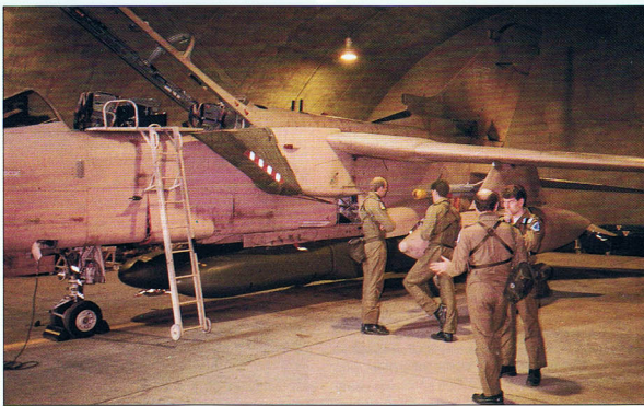
Podczas przygotowań do szturmu na lotniska zbrojnicze w Dhahran wsuwają zasobnik JP233 pod Tornado. Przednia część zasobnika jest już na miejscu.
