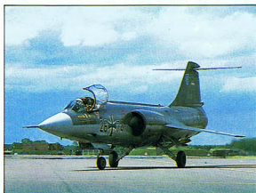
Na tym zdjęciu F-104G dokładnie widać, dlaczego Starfighter był nazywany „pociśkiem z człowiekiem w środku”. Widoczne są również golenie podwozia głównego rozchylone pod dużym kątem.
