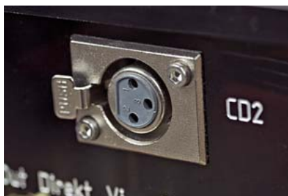
W tej wersji Emittera I zainstalowano również wejścia XLR, okablowane standardowo, tj. z „gorącym” pinem 2.
