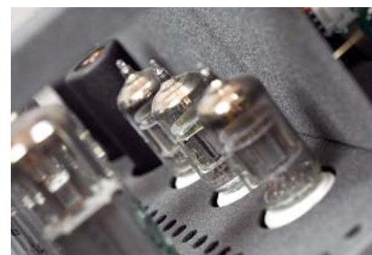
Na pierwszym planie lampy przedwzmacniacza, a w głębi ukryte w metalowych kubkach lampy przedwzmacniacza gramofonowego, sekcji MM.
