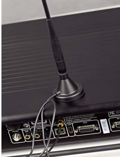
W komplecie dostajemy antenkę do komunikacji WLAN.
