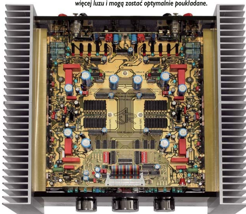
Dzięki oddzieleniu zasilania, układy wzmacniacza mają znacznie więcej luzu i mogą zostać optymalnie poukładane.
