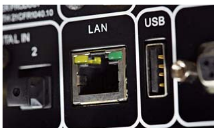
Gniazda znane z komputera – Ethernet (na CAT-5) oraz USB.
