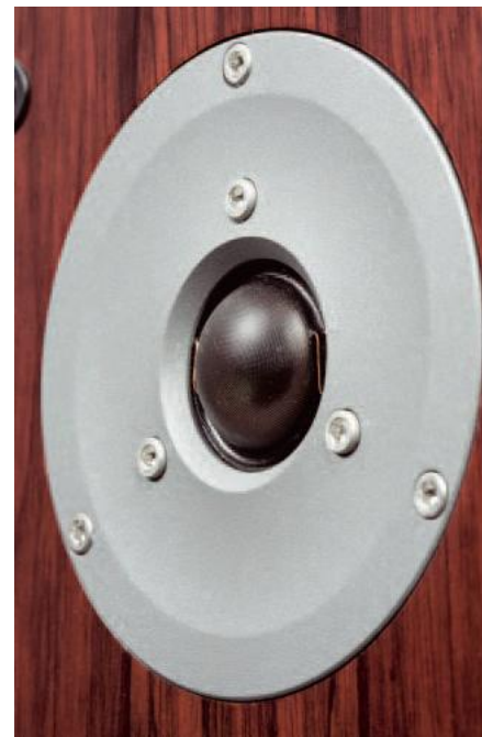
Ponad trzydzieści lat temu Duńczycy wpadli na pomysł, aby ustanowić własny standard kopułki – 28 mm – alternatywny dla bardziej popularnej średnicy 25 mm. Kolejne generacje D28 Dynaudio różnią się magnesami, frontami, powleczeniem, ale podstawy konstrukcji pozostają niezmiennie – kopułka jest jedwabna, a doprowadzenie sygnału do cewki widać na zewnątrz (charakterystyczne „wąsy”).
