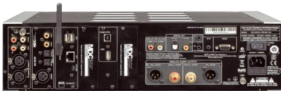
Tylko prawa sekcja wyjść jest zainstalowana na stałe, pozostała część tylnej ścianki obejmuje wymienne kieszenie.
