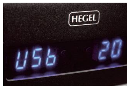
Niebieską barwę wyświetlacza znamy choćby z przetworników Hegla, matryca ma przede wszystkim informować o wybranym źródle oraz ustalonej mikroprocesorowo wartości wzmocnienia.
