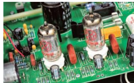
Triody JJ Electronic – zaangażowani będą je mogli wymieniać na inne modele, typ 12AU7 to jeden z popularniejszych.
