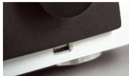
Pendraj w muzyką podłączymy wygodnie do gniazda USB na przednim panelu, lecz w ten sposób odtworzymy tylko pliki 16/48, a materiał 24/192 trzeba podać do USB na tylnej ścianie – w ramach modułu BluOS.
