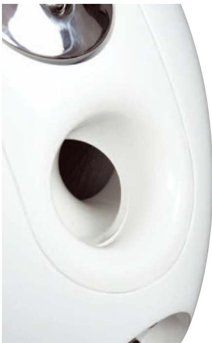
„Jajo” jest układem bas-refleks, którego tunel musiał być dość długi, aby uzyskać odpowiednio niską częstotliwość rezonansową. Tunel nie biegnie prosto, lecz zakręca, układając się przy ściance obudowy.
