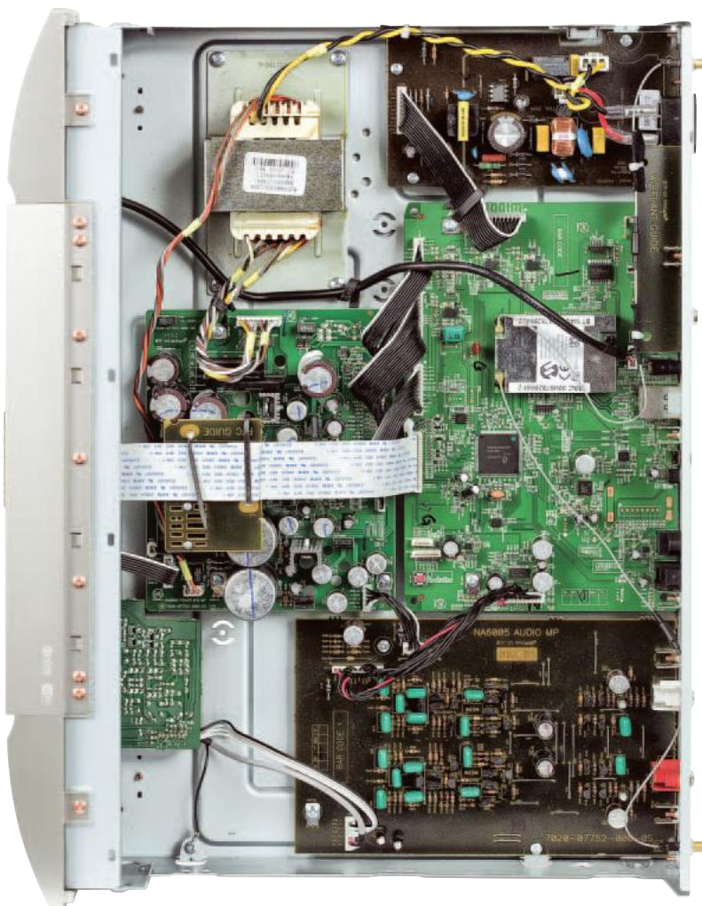
Elektronikę cyfrową obudowano dużym zasilaczem, sekcja analogowa jest również rozbudowana.
