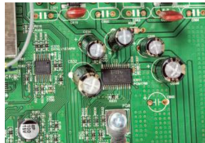
Kość przetwornika cyfrowo-analogowego – popularny Burr Brown PCM 1795.
