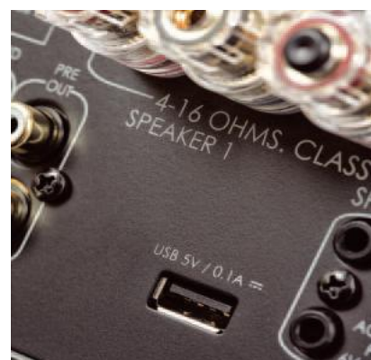
Port USB to tylko źródło zasilania dla zewnętrznych urządzeń.
