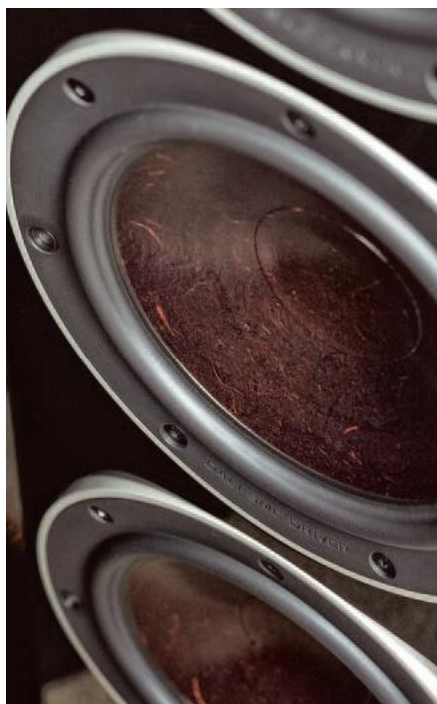
Każda z trzech „18-tek” pracuje w innym zakresie częstotliwości: najniższa do 500 Hz, środkowa do 800 Hz, położona najwyższej, już w całym zakresie nisko-średniotonowym, do 2,5 kHz.
