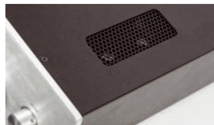
W górnej ścianie nie ma typowych szczelin wentylacyjnych, bo końcówki mocy przykręcono do dolnej płyty, natomiast jest „okienko” nad lampami w sekcji przedwzmacniacza.
