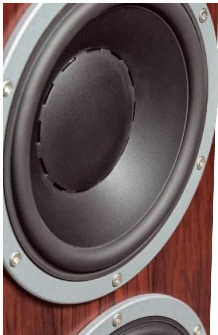
Znane od dawna, 18-cm nisko-średniotonowe Dynaudio, z cewką 75-mm, po raz pierwszy zastosowano jako niskotonowe w układzie trójdrożnym chyba właśnie w Focusie 340.
