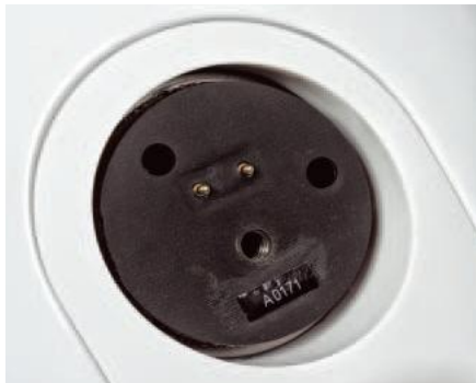
Tak wygląda miejsce, w którym instalujemy wysięgnik z głośnikiem wysokotonowym – ponad numerem seryjnym widać gwint śruby mocującej, a powyżej dwa bolce z sygnalem.
