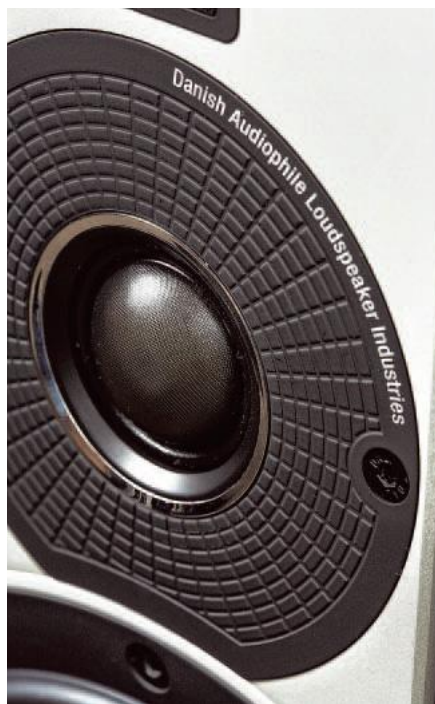
28-mm jedwabna kopułka byłaby zdolna przetwarzać aż do 20 kHz, ale przeznaczony dla niej zakres z premedytacją zawężono, oddając najwyższe częstotliwości (powyżej 14 kHz) przetwornikowi wstęgowemu.
