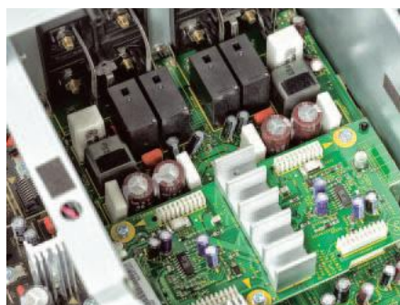
Impulsowe końcówki mocy wymagają tylko szczątkowego radiatora, ale potrzebują filtrów wyjściowych.
