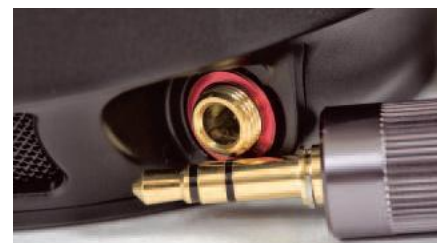
W każdej muszli znajduje się 3,5-mm gniazdo, producent wzbogacił złącze o zakręcany mechanizm.
