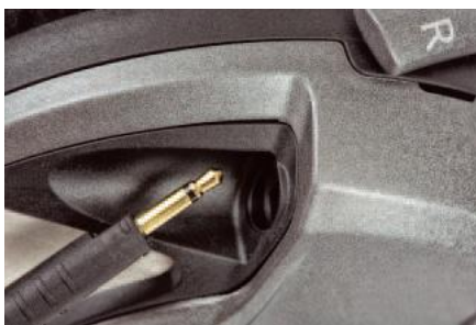
Efektowny kanał gniazda na zewnętrznej części muszli pięknie komponuje się z futurystycznym stylem HD700 , choć podłączenie i zablokowanie wtyku wymaga nieco wprawy.
