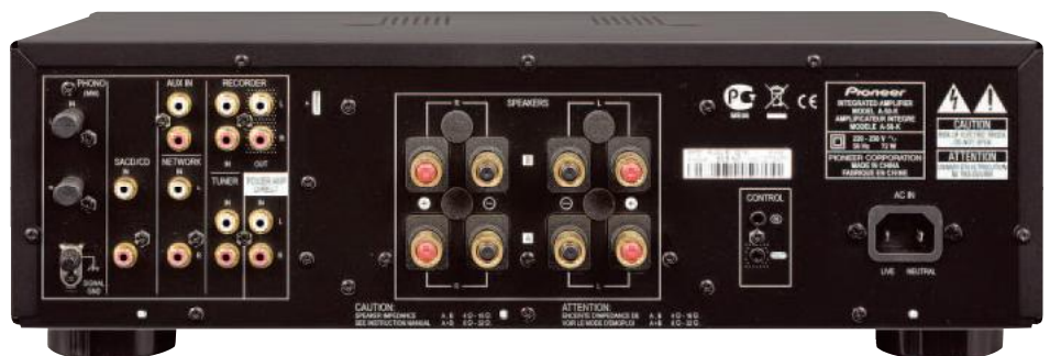
Przejrzyście i porządnie, wszędzie złączenia, a terminale głośnikowe z metalowymi nakrętkami.
