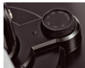
Przeciwwaga z czytelną skalą, nacisk dla fabrycznej wkładki powinniśmy ustalić na 3,5 G.
