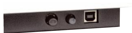
Z boku, na dodatkowym panelu, znajduje się gniazdo USB dla komputera, z regulacją poziomu (sygnału docierającego do przetwornika analogowo-cyfrowego) i włącznik obrotów.
