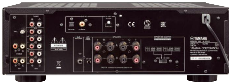
Obok wyjść głośnikowych występuje selektor impedancji – znany od dawna z wielokanałowych amplitunerów Yamahy.
