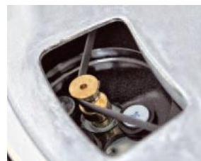
Klasyczny napęd paskowy – silnik przekazuje obroty na wewnętrzną część talerza.
