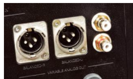
Wyjścia analogowe podzielono na dwie sekcje o stałym i regulowanym napięciu, w każdej jest para XLR i RCA.
