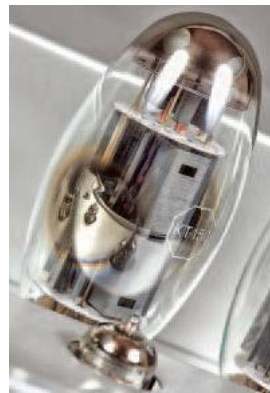
Lampy KT150 wyróżniają się wielkością i kształtem. Bańka jest niezwykle charakterystyczna i przypomina bombę.
