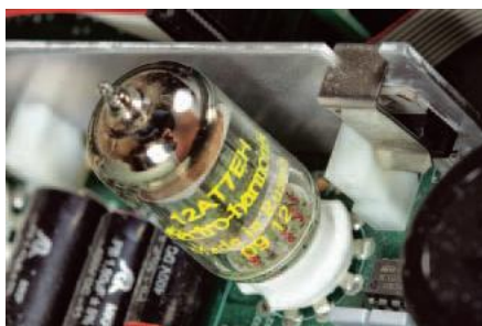
W sterowaniu pracują podwójne triody 12AT7EH Electro-Harmonix.
