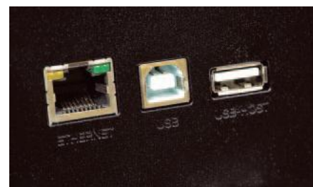
Port sieci LAN (jest też łączność Wi-Fi) oraz dwa USB o różnym przeznaczeniu (zależnym od konfiguracji).
