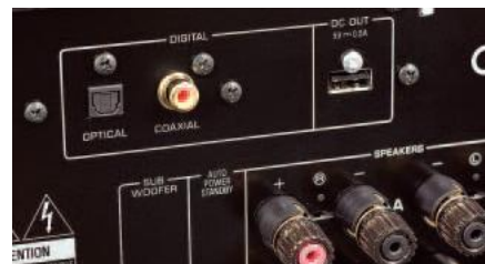
Wejścia cyfrowe – ponieważ w środku A-S501 znajduje się przetwornik C/A. Gniazdo USB jest jednak tylko źródłem zasilania dla zewnętrznych akcesoriów.
