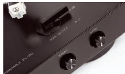
'Start/Stop' – do prawidłowej pracy automatyki gramofonu trzeba jeszcze zadeklarować średnicę płyty.
