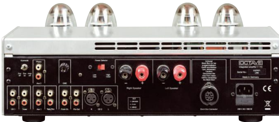
Jak na wzmacniacz lampowy, tylna ścianka jest wyjątkowo „bogata”. wejścia liniowe RCA i XLR, gniazdo dla zewnętrznego zasilacza, przełączniki trybu pracy. Jest jednak tylko jeden komplet wyjść głośnikowych, czyli nie ma wyjść dedykowanych różnym impedancjom
