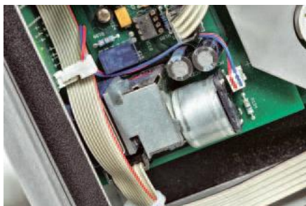
Potencjometr jest napędzany przez silniczek.
