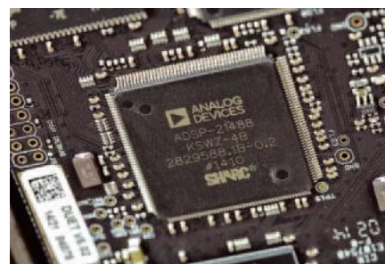
Procesor DSP Analog Devices z gamy Sharc – w sprężce A/V odpowiada często za wielokanałowe czary, tutaj zajmuje się kształtowaniem sygnałów stereo.
