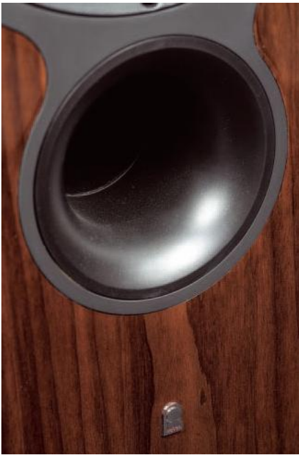
Na wyposażeniu znajduje się zatyczka bas-refleksu będąca najprostszym sposobem radykalnej zmiany charakterystyki w zakresie niskich częstotliwości.
