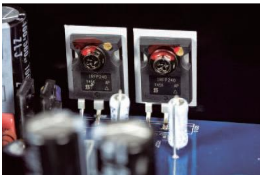
W każdym kanale pracują dwie pary tranzystorów wyjściowych.
