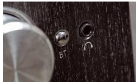
Nie ma wejścia podręcznego, lecz nie zabrakło wyjścia słuchawkowego (3,5 mm).
