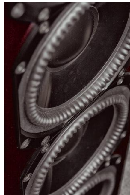
Membrany niskotonowe przygotowano z utwardzonego (mineralizowanego) polipropylenu. Paradigma wykorzystuje ten materiał konsekwentnie. Bardziej zwraca uwagę „karbowanie” zawieszania, mające poprawić jego parametry.
