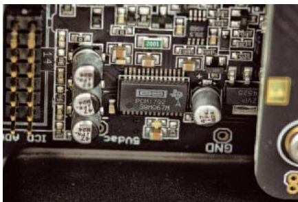
Po wyjściu z sekcji przedwzmacniacza (a przed wejściem na końcówki mocy) sygnał jest znów zamieniany na postać analogową, za co odpowiada także 24-bitowy skalak Burr Browna.
