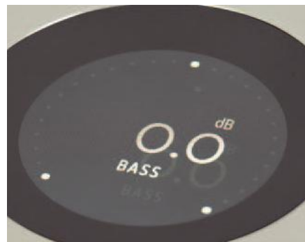
Czytelny, graficzny wyświetlacz przekazuje wiele informacji o pracy urządzenia, procesory DSP wykorzystano, aby realizować różne funkcje, między innymi regulację barwy – o tyle wyjątkową, że charakterystyki filtrów możemy modyfikować.
