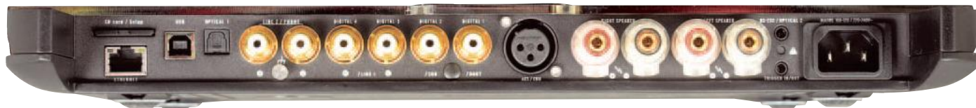
Komplet kilku znanych gniazd – na pozór nic specjalnego, ale Devialet pozwala niemal dowolnie przyporządkować funkcje do fizycznych złączy.
