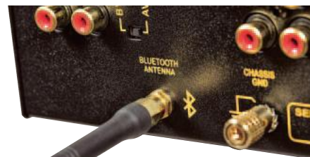
Obudowa jest w całości metalowa, więc konieczna była zewnętrzna antena dla transmisji Bluetooth.
