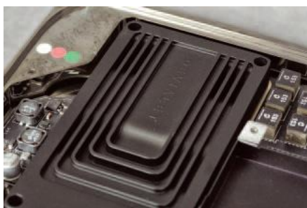
Zasilacz w formie niewielkiej kostki wystarcza, aby wygenerować ponad pół kilowata mocy wyjściowej.
