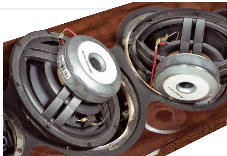
Niskotonowy tym bardziej może się podobać – mocny kosz, wentylacja pod dolnym zawieszeniem, duży otwór wentylacyjny w układzie magnetycznym.
