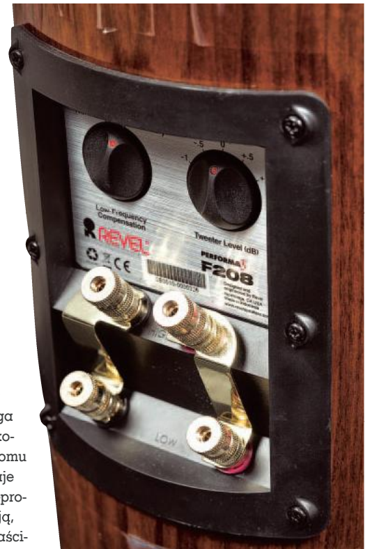
W oprawce podwójnego gniazda przyłączeniowego odnajdziemy jeszcze inne elementy wyposażenia – regulatory charakterystyki w zakresie niskich i wysokich częstotliwości. Regulator niskich jest dwupozycyjny, ale zakres zmian jest tutaj bardzo duży. Regulator wysokich jest pięciopozycyjny, lecz kroki są bardzo delikatne.
