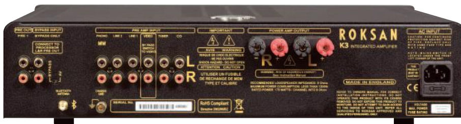
Wejść liniowych wystarczy na każdą okazję, jest również przedwzmacniacz gramofonowy MM.
