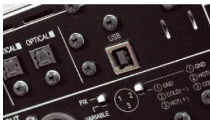
Wejście USB przyjmuje sygnały 32 bity/384 kHz oraz DSD128.
