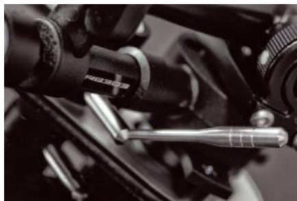
Antyskating w Redze przygotowano z wykorzystaniem magnesów. Ustawia się go przesuwając trzpień umieszczony pod miejscem spoczynkowym ramienia.
