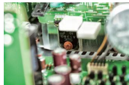
Końcówki mocy zainstalowano tuż przy dolnej ściance, każdy z kanałów obsługuje para tranzystorów Sanken.
