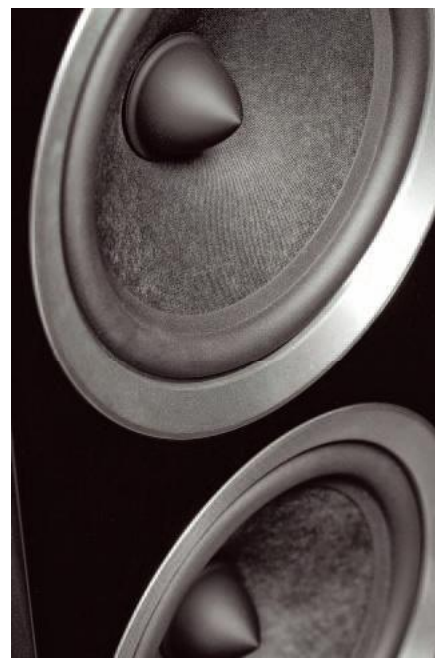
W membranach niskotonowych też jest trochę Kevlaru – nie jest on jednak tutaj użyty tak jak w membranie średniotonowej, w strukturze plecionej, ale jest domieszką w typowej celulozowej pulpce.
