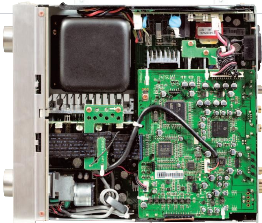
Dla elektroniki audio przygotowano dwie płytki – dolna jest bazowym przetwornikiem C/A z torem analogowym, górna zawiera procesory sygnałowe.
