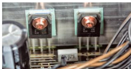
Wzmacniacze mocy zbudowano z czterech (dwa na kanał) bipolarnych tranzystorów 2STC4468/2STA1695.
