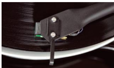
Główka ramienia to rozplaszczona część rurki. Uchwyt na palec – osobny element przykręcany wraz z wkładką.
