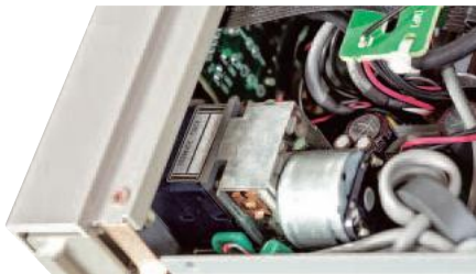
Układ odpowiedzialny za poziom wyjścia RCA i gniazda słuchawkowego wykorzystuje klasyczny potencjometr analogowy.
