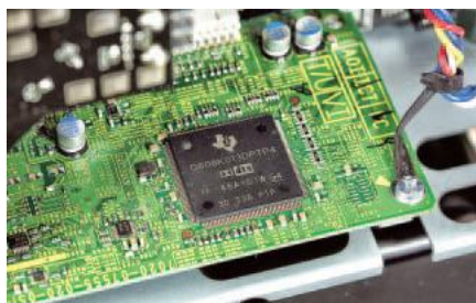
Procesor DSP realizuje funkcje upsamplera i filtrów Hi-Bit.
