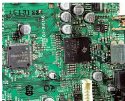
Sygnały cyfrowe z zewnątrz są przygotowywane do dalszej obróbki w 32-bitowym procesorze Texas Instruments.
