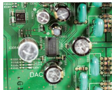
Niezależnie od wejścia czy płyty, konwersja C/A odbywa się w układzie Cirrus Logic.
