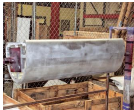
Obudowa kolumn S5 przygotowana do malowania.
