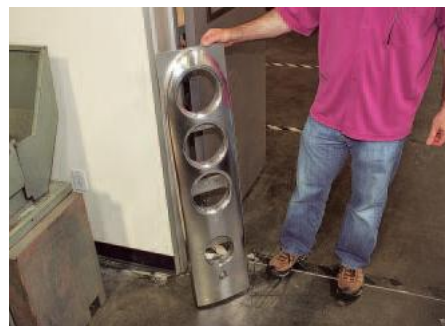
Przednia ścianka modelu Q3 – jej frezowanie z litego bloku aluminium o grubości 6 cm trwa aż sześć godzin.
