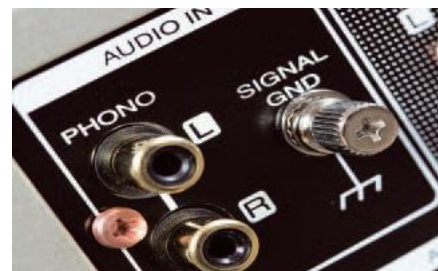
Wzmacniacz nie dostał zadania obróbki sygnałów cyfrowych, może jednak przyjąć sygnał z gramofonu.
