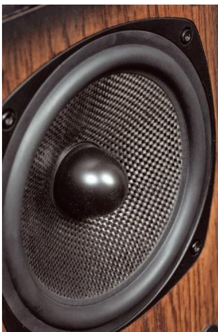
Głośniki nisko-średniotonowe mają membrany mniej klasyczne niż obudowa, w której siedzą, ale plecionkę z włókna węglowego Castle stosuje już od wielu lat. Jak wszystkie plecionki, wykazuje się przede wszystkim dobrym rozpraszaniem rezonansów, choć mniejszą sztywnością niż membrany metalowe, sandwiczowe czy nawet celulozowe.
