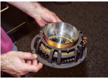
Głośnik niskotonowy modelu Q5. Po zdjęciu magnesu widać ogromną cewkę
