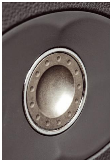
Wklęsła kopułka wysokotonowa, a wokół niej jeszcze dodatkowa, delikatna, ale obszerna wklęsłość – tworząca profil wpływający na charakterystyki kierunkowe.
