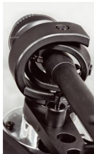
Klasyczne, kardanowe zawieszenie ramienia zostało zbudowane z hartowanych ostrzy i regulowanych punktów, w których są oparte. Mniejsza obejma została przesunięta w stosunku do ramienia pod takim samym kątem jak główka ramienia.
