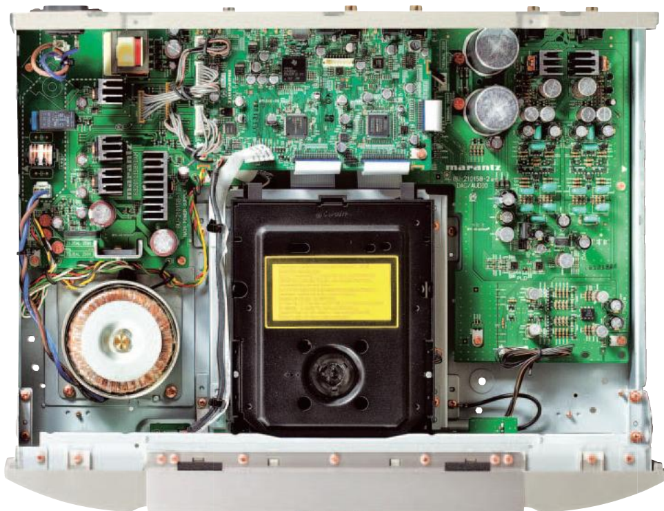
Wewnątrz widać wyraźnie trzy główne sekcje: zasilacz, mechanizm (z wejściami cyfrowymi) oraz przetwornik DAC.
