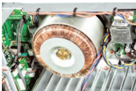
Podobnie jak w odtwarzaczu, transformator zasilający zaekranowano, ale od sekcji audio oddziela go również radiator.
