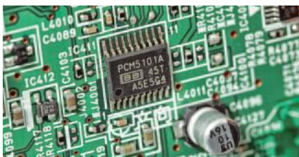
Nowoczesny DAC Texas Instruments PCM5101 potrafi przyjąć sygnały PCM o rozdzielczości sięgającej 32 bitów i częstotliwości próbkowania 384 kHz.
