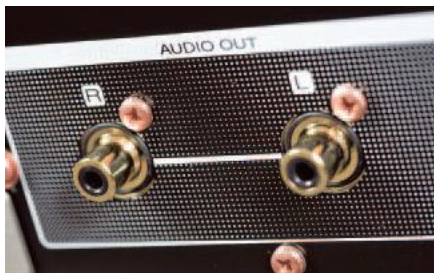
Wyjście analogowe uhonorowano lepszymi złączami RCA.
