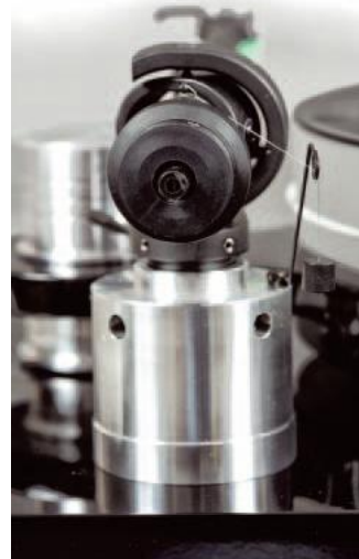
Wysokość VTA regulujemy poprzez wykręcenie dwóch widocznych na zdjęciu śrub i przesunięcie kolumny ramienia.
