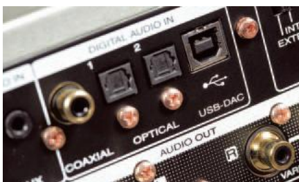
Oprócz cyfrowych wejść w najpopularniejszych standardach, HD-DAC1 ma także wejście analogowe w postaci gniazda mini-jack.
