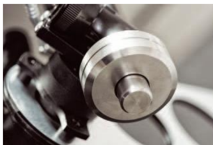
Przeciwwaga porusza się po precyzyjnym, stalowym trzpieniu
