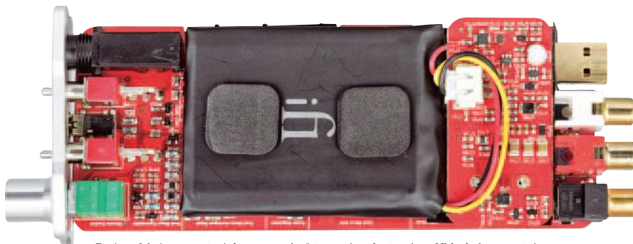
Duża, obłożona materiałem „paczka” to ogniwa bateryjne. Układy konwertujące zbudowano z dwóch scalaków Texas Instruments.
