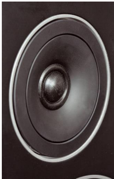
Wyprofilowanie wokół wysokotonowego wraz z jego izolacją od wibracji frontu obudowy znamy już z poprzednich konstrukcji Jamo. W nowej serii Concert zmieniono jednak sam przetwornik – poprzednio membrana była klasycznie kopułkowa, a teraz jest kopułkowo-pierścieniowa.
