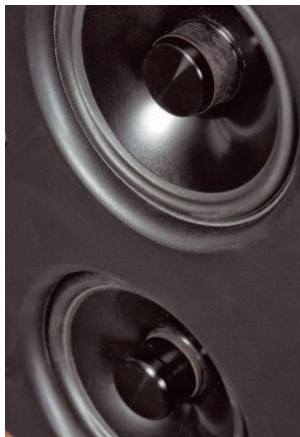
Już z zewnątrz widać różnice między „15-tkami” nisko-średniotonowymi (na zdjęciu dolna) a „15-tką” średniotonową – inaczej wygląda korpus korektora fazy.
