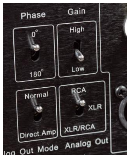
Przetwornik Ayona jest przygotowany do pracy z zewnętrznym przedwzmacniaczem lub bezpośrednio z końcówką mocy. Możemy więc zmienić wzmacnienie układu, ograniczyć maksymalną siłę głosu przy włączaniu i zadbać o inne „drobiazgi”. Ponieważ ustawia się je na stałe w danym systemie, umieszczono je na tylnej ścianie.
