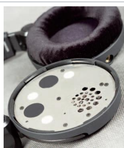
Zestaw różnej wielkości i różnie tłumionych otworków – słuchawka z systemem S-Logic to precyzyjnie dostrójony ustrój akustyczny.
