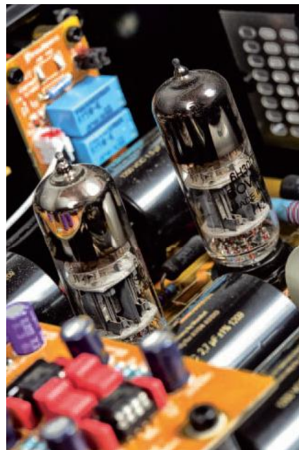
Wyjścia w droższych źródłach Ayona zawsze bazują na podwójnych triodach 6H30 produkcji Sovteka. Tutaj pojawiają się dwie takie lampy w każdym kanale, ponieważ to układ zbalansowany.
