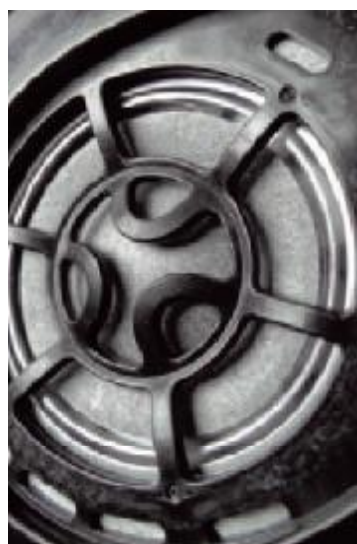
Free Edge Nano Fiber Driver w całej okazałości – kolejny z głośnikopodobnych przetworników na rynku – dookoła widać elastyczne zawieszenie.
