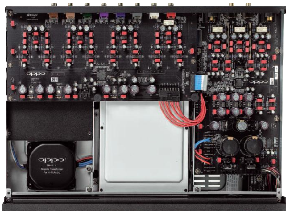
Wewnątrz idealny porządek. Choć płytki umieszczono piętrowo, cała sekcja audio (podzielona na segmenty stereo i wielokanałowe) znajduje się na górze.
