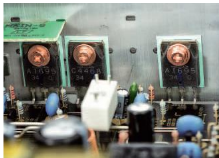
Sygnaly po konwersji C/A trafiają do konwencjonalnych, analogowych wzmacniaczy; w każdym kanale pracuje para tranzystorów Sanken 2SA1695 + 2SC4486.
