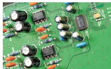
Burr Brown PCM1796 to układ, który znajdziemy w wielu odtwarzaczach cyfrowych; charakteryzuje się niskimi zniekształceniami, dobrą odpornością na jitter, jest łatwy w aplikacji... i niedrogi.
