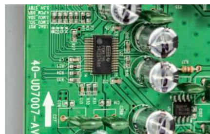
Marantz przekonywał o słuszności stosowania 16-bitowych przetworników w odtwarzaczach CD, tutaj spektrum sygnałów jest jednak znacznie szersze i trzeba było sięgnąć po układ 32-bitowy.
