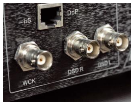
Obecność tych gniazd sugeruje aspiracje studyjne (3 x BNC dla sygnału DSD) i możliwość przesyłu tego typu sygnału (w przyszłości, na razie to opcja) przez kabel ethernetowy, np. z odtwarzaczy sieciowych.
