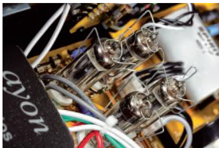
Absolutna rzadkość – pełnokresowy prostownik lampowy.
