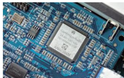
Tajemnica obróbki sygnałów audio kryje się w procesorze Analog Devices, w którym zaszyto algorytm upsamplingujący Anagram Technologies Q5.
