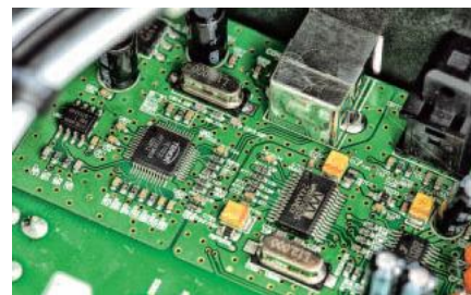
DAC we wzmacniaczu to pomysł... sprzed dwudziestu lat, potem zapomniany, a teraz odświeżony. Układy nie są tak rozbudowane jak w odtwarzaczach cyfrowych, choć zwykle mamy do dyspozycji także wejście USB. To w Puro 800 obsługiwane jest przez układ Tenora TE7022L. Sam przetwornik C/S jest inny niż w CDP – Cirrus Logic CS4392 – niedrogi układ ze zintegrowaną sekcją konwersji I/U i filtracją.
