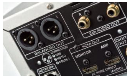
Na każdym kroku widać dbałość o sygnały audio, przygotowano analogowe wyjście zbalansowane, producent zachęca także do korzystania z dwóch wyjść HDMI – jednego tylko dla obrazu, drugiego dla dźwięku.
