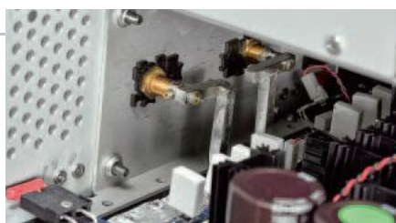
Mając na uwadze wysoką moc wyjściową, zastąpiono okablowanie głośnikowe parą grubych zwor.
