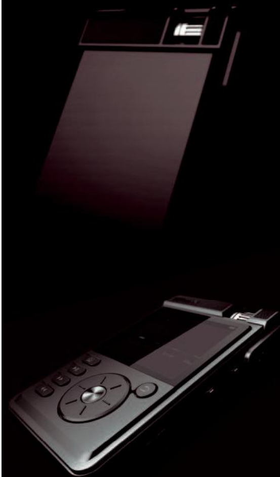
Włącznik / włącznik ekranu, na środku wejście optyczne, z prawej wyjście optyczne wewnątrz gniazda słuchawkowego.
