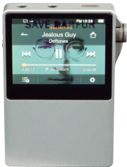
Ekran jest bardzo czuły, wszystkie elementy interfejsu są interaktywne, np. utwór można przewijać, sunąć palcem po żółtej kropce.
