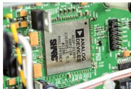
Okazały procesor DSP Sharc (Analog Devices) zajmuje się wstępną obróbką danych cyfrowych.
