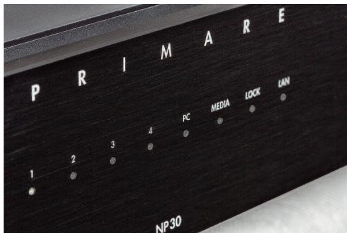
Bez wyświetlacza, jedynie z rządkiem informacyjnych diod – rolę sterownika i matrycy przejmują smartfony lub tablety.
