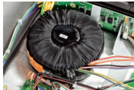
Zainstalowano duży transformator toroidalny i przygotowano niezależne odczepy dla sekcji cyfrowej, analogowej i komunikacji sieciowej.
