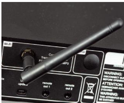
Moduł Wi-Fi uzupełnia bazową, przewodową transmisję LAN, może się przydać w instalacjach bez odpowiedniego okablowania.
