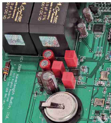
Piękne kondensatory wyjściowe, a przed nimi bateria zasilająca.
