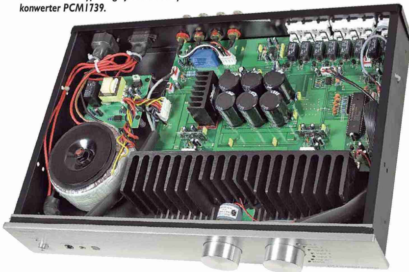
Przejrzysty układ z rozbudowanym zasilaczem, na uwagę zasługuje potężny, odlewany radiator, który ma wiele wspólnego z wysoką mocą urządzenia.
