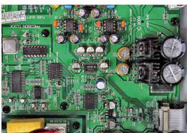
Przetwornik Burr-Browna z układem upsamplera.
