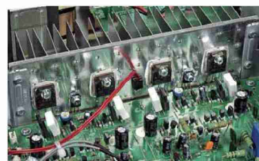
Końcówkę mocy zbudowano z elementów dyskretnych.
