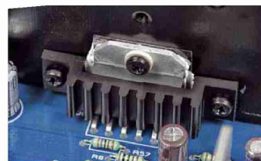
Końcówka mocy opiera się na pojedynczych układach scalonych dla każdego kanału.
