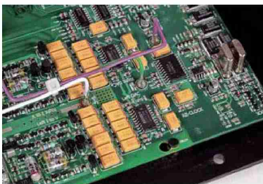
Przetworniki C/A PCM1704 - tutaj w najlepszej wersji „K”.
