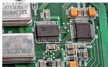
Przetwornik C/A Analog Devices, a obok dwa duże oscylatory kwarcowe.
