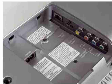
Wszystkie gniazda ukryto pod maskującymi panelami.
