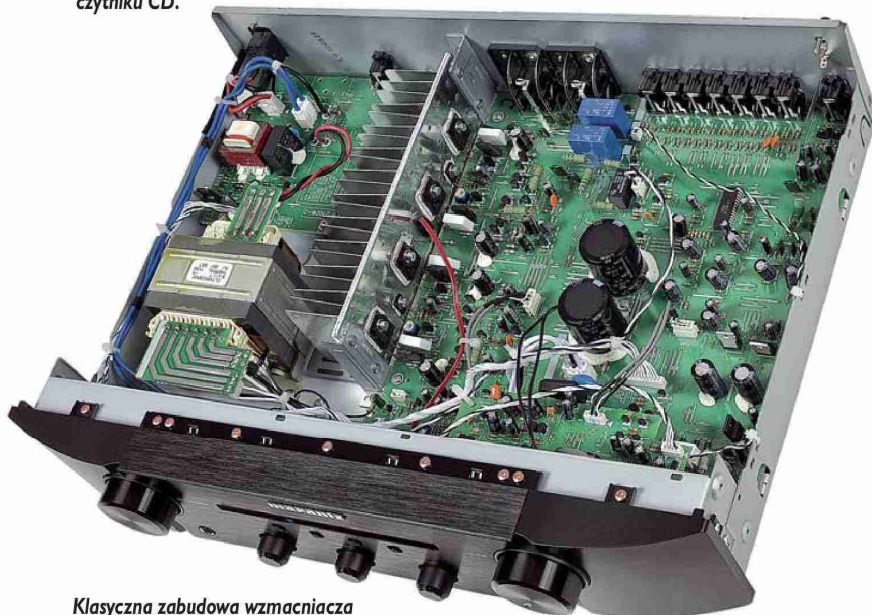
Klasyczna zabudowa wzmacniacza - z radiatorem oddzielającym sekcję audio od zasilacza.
