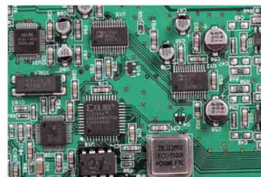
Cyfrowe serce urządzenia – odbiornik cyfrowy, USB, upsampler oraz przetwornik, a obok kwarc.
