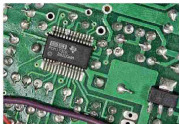
Sercem układu cyfrowego jest dość stary konwerter PCM1739.
