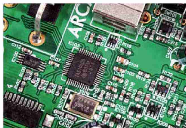
TASI020B, programowalny odbiornik USB, tutaj z oprogramowaniem przygotowanym przez dCS-a. Bomba!
