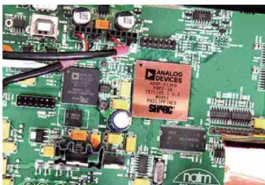
Cyfrowe serce Naima – potężne układy DSP Analog Devices.
