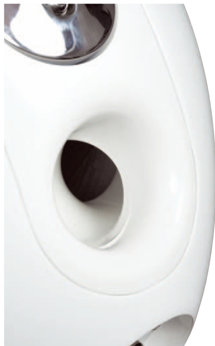
„Jajo” jest układem bas-refleks, którego tunel musiał być dość długi, aby uzyskać odpowiednio niską częstotliwość rezonansową. Tunel nie biegnie prosto, lecz zakręca, układając się przy ściance obudowy.
