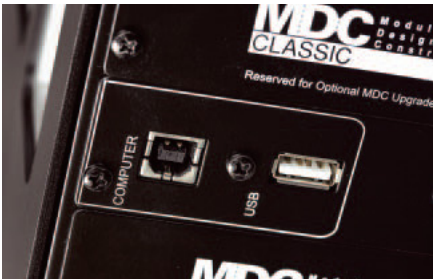
Asynchroniczne wejście USB pozwala na podłączenie komputera, akceptując dane PCM 24/192.
