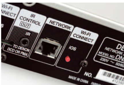
Czerwone przyciski wspomagają konfigurację modułu Wi-Fi.
