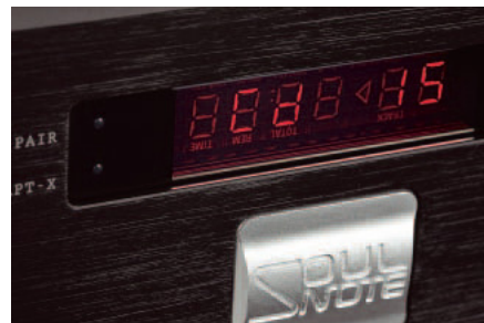
Wyświetlacz przede wszystkim sygnalizuje wybrane wejście i ustalony poziom wzmocnienia. Obok matrycy są jeszcze dwie diody kontrolujące pracę modułu Bluetooth.
