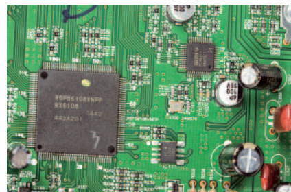
Duży scalak DSP jest jednym z głównych procesorów do obróbki sygnałów cyfrowych, przez niego przechodzą dane z różnorodnych formatów.
