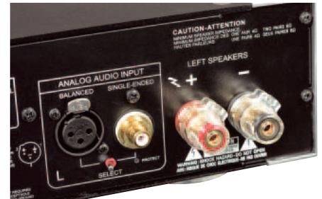
Każdy z kanałów ma swój własny moduł wejść i wyjść. O tym, czy korzystamy z gniazd RCA, czy XLR, decyduje ustawienie hebelkowego przełącznika.
