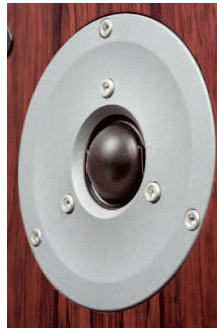
Ponad trzydzieści lat temu Duńczycy wpadli na pomysł, aby ustanowić własny standard kopułki – 28 mm – alternatywny dla bardziej popularnej średnicy 25 mm. Kolejne generacje D28 Dynaudio różnią się magnesami, frontami, powłoczeniem, ale podstawy konstrukcji pozostają niezmiennie – kopułka jest jedwabna, a doprowadzenie sygnału do cewki widać na zewnątrz (charakterystyczne „wąsy”).
