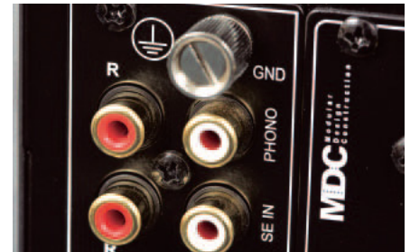
Wśród kilku wejść analogowych jest też opcja dla gramofonu – zarówno z wkładką MM, jak i MC.
