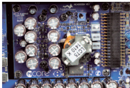
NAD sięgnął po gotowe moduły końcówek mocy firmy Hypex.
