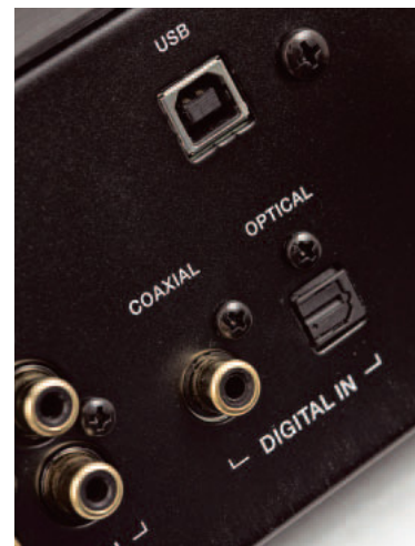
Złącze USB potrafi przyjąć sygnał PCM o rozdzielczości aż do 32 bitów i częstotliwości próbkowania 384 kHz.
