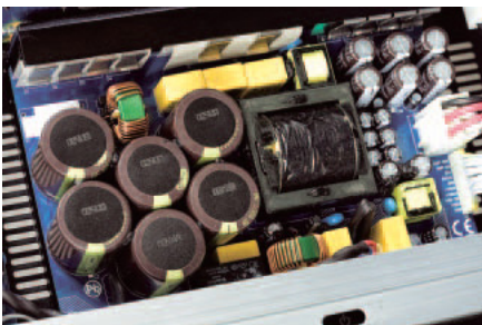
Zasilacz to również układ impulsowy.
