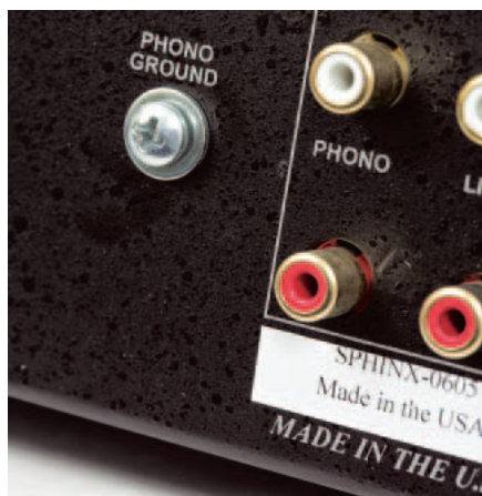
Wejście gramofonowe z bolcem uziemiającym w formie śruby – ten szczegół jest może mało elegancki, ale tak samo skuteczny.
