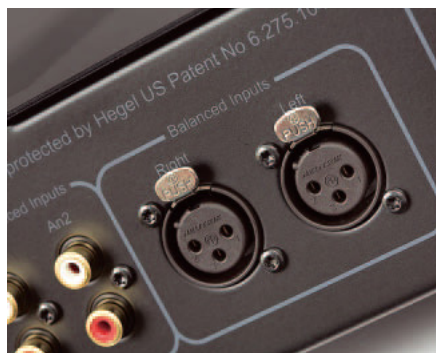
Obok RCA są też gniazda XLR, choć sam układ wzmacniacza nie jest zbalansowany.
