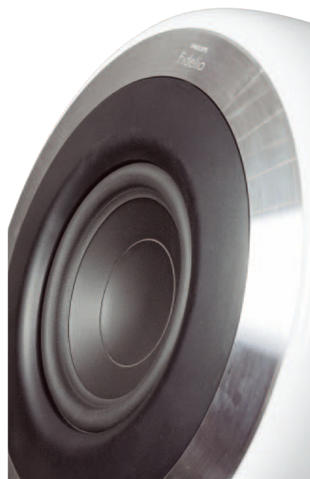
W bardzo solidnej i luksusowej obudowie pracuje dość skromny, 17-cm przetwornik. Dla swobodnego przetwarzania najniższego basu moglibyśmy sobie życzyć większej jednostki, pamiętajmy jednak, że nie jest to przetwornik niskotonowy, ale nisko-średniotonowy, a przetwarzaniu średnich częstotliwości, zwłaszcza ich szerokiemu rozpraszaniu, duża średnica membrany nie służy. Wybór tej wielkości przetwornika jest więc dobrym kompromisem
