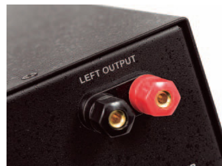
Lampy pracują w sekcji wejściowej, ale wyjścia głośnikowe są podłączone do końcówki pracującej w klasie D – dlatego nie jest potrzebne żadne, charakterystyczne dla wzmacniaczy lampowych, wyposażenie w niezależne wyjścia dla różnych impedancji czy przełączniki trybu pracy.
