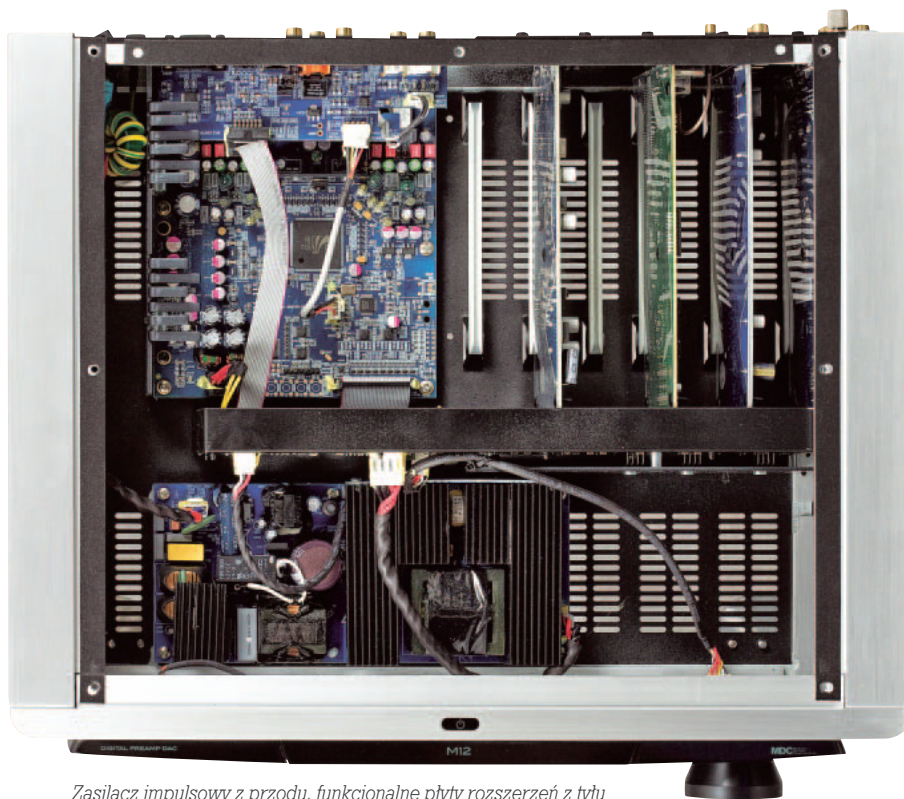
Zasilacz impulsowy z przodu, funkcjonalne płyty rozszerzeń z tyłu (jak w komputerach), na szczęście M21 nie potrzebuje wentylatorów.
