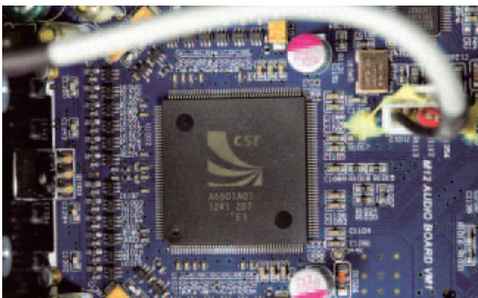
Główny procesor DSP zajmuje się obróbką sygnałów ze wszystkich źródeł i modułów.
