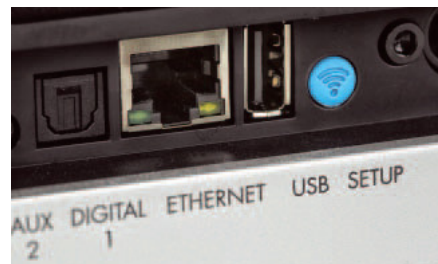
Panel połączeniowy, oprócz sieci LAN, zawiera cyfrowe wejście (optyczne), a nawet port analogowy. Ethernet można zawsze odłożyć na rzecz Wi-Fi, port USB pełni tylko rolę czytnika danych do aktualizacji oprogramowania.
