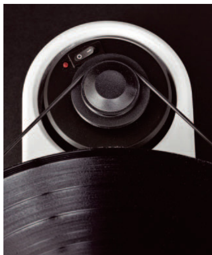
Silnik odprężony od chassis – trzeba zwrócić uwagę, by nie dotykał ramy.
