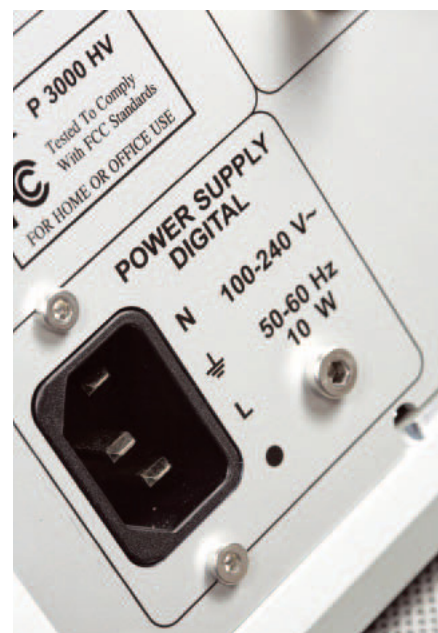
Do przedwzmacniacza prowadzą aż dwa kable sieciowe – niezależnie dla obwodów audio i cyfrowej sekcji sterującej (na zdjęciu).
