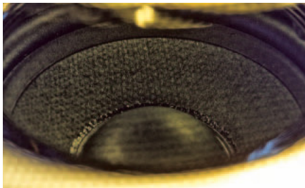
9-cm głośnik nisko-średniotonowy schowany w zagłębieniu stożkowej obudowy.
