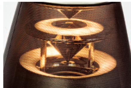
Moduł przetworników oraz dyfuzorów służy dookólnemu rozpraszaniu dźwięku.
