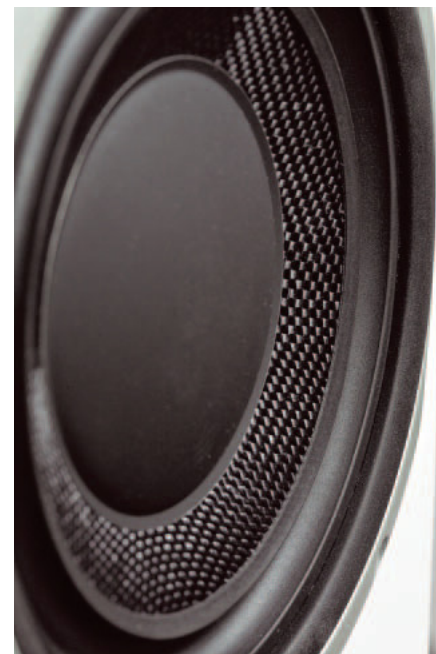
Membrany niskotonowe są wielowarstwowe – z przodu widać plecionkę z włókna szklanego, która jest sklejoną z warstwą celulozy i dodatkowo usztywniona dużą nakładką. Zawieszenie jest „odwrócone”, jednak przygotowane do dużych wychyleń.
