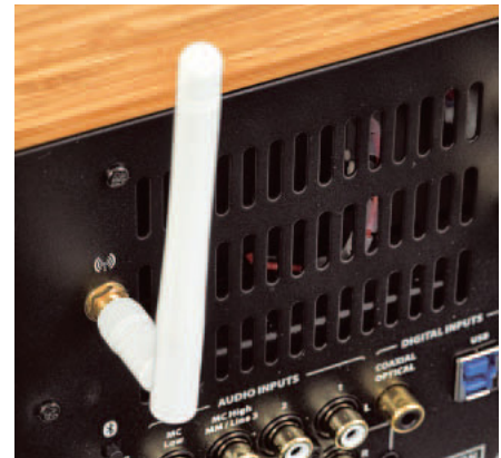
Jest również moduł bezprzewodowy Bluetooth ze zbliżeniowym dodatkiem NFC.
