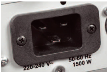
Elementy C19/C20 przesyłają prąd o natężeniach ponad 20 A.
