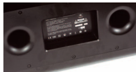
Na dolnej powierzchni znajdują się otwory bas-refleksów, jest też drugi panel przyłączeniowy z gniazdem sieciowym i cyfrowym wejściem optycznym.
