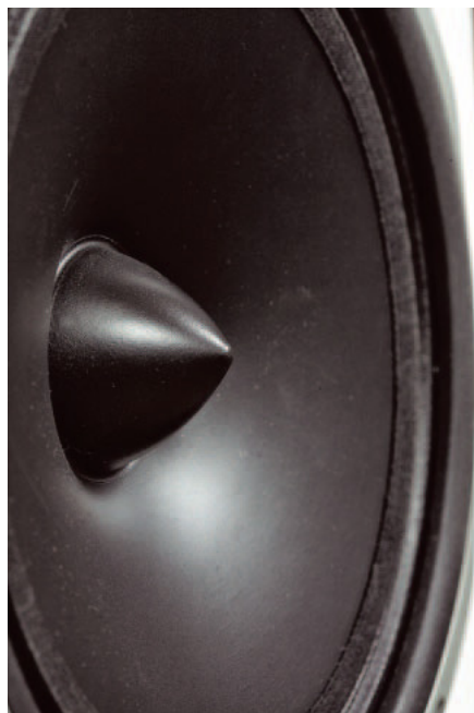
Lekka, celulozowa membrana połączona z cewką o niewielkiej średnicy, zawieszona na lateksowej fałdzie o niskiej stratności – klasyczny, ale rasowy głośnik średniotonowy.
