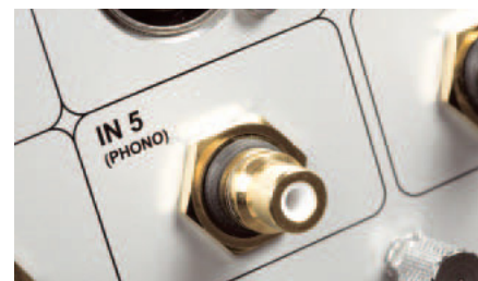
Jedno z wejść oznaczono jako „Phono”, ale aby spełniało swoje zadanie, trzeba dokupić (i zainstalować wewnątrz) moduł przedwzmacniacza gramofonowego.
