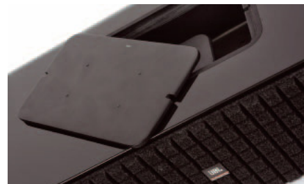
Górną pokrywą można odsłonić, uzyskując dostęp do gniazd i „grzybka” umożliwiającego zwinięcie i ukrycie przewodów.
