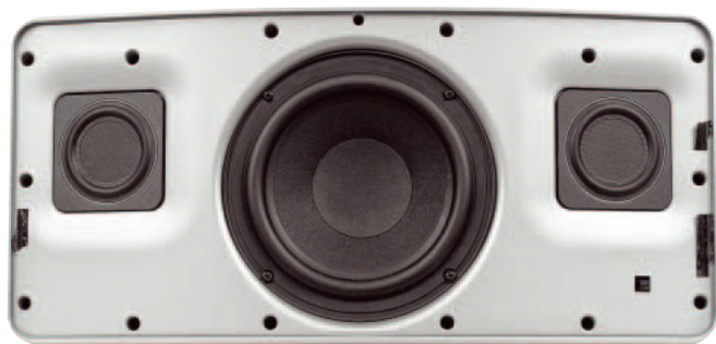
Układ głośnikowy tworzy para szerokopasmowych, wspomaganych jednym niskotonowym, wspólnym dla obydwu kanałów.
