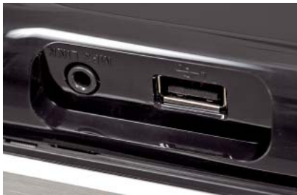
Jedno z gniazd USB umieszczono z przodu w towarzystwie wejścia analogowego dla odtwarzaczy przenośnych.
