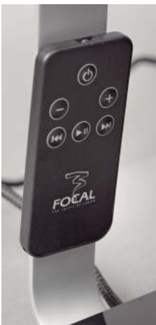
Mały pilot mocowany jest magnesem na ramie głośnika.
