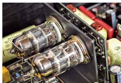
Lampy na wyjściu to rzecz, którą Xindak przećwiczył już wcześniej, w niedrogim przetworniku DAC-5. Tutaj są dwie i pracują w układzie zbalansowanym.
