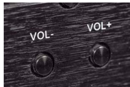
W przedwzmacniaczu nie ma klasycznej galki, siłę głosu reguluje się przyciskami.
