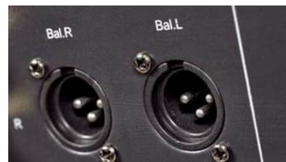
Wyjścia zbalansowane przetwornika – sygnał na nich jest naprawdę różnicowy.
