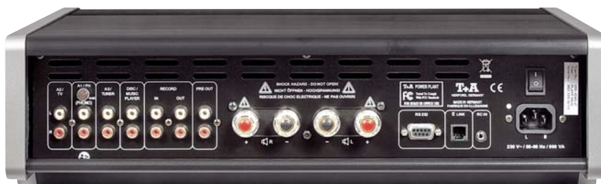
Klasyczny układ przyłączy – z lewej rzędek gniazd wejściowych, pośrodku gniazda głośnikowe, po prawej gniazda komunikacji oraz sieciowe.
