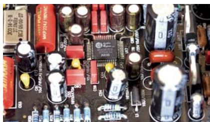
Znakomity przetwornik C/A o 32-bitowej precyzji (przynajmniej w teorii).
