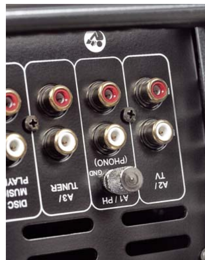
Jedno z wyjść wyposażono w zacisk masy – można bowiem w Power Plancie zainstalować opcjonalną płytkę z przedwzmacniaczem gramofonowym.
