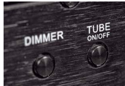
Napięcie dla lamp wyjściowych można wyłączyć.
