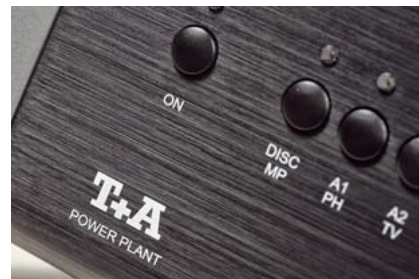
Przyciski układu selektora źródeł – mamy aż pięć wejść liniowych. Jedno z nich można zamienić na wejście gramofonowe, instalując wewnątrz opcjonalną płytkę.
