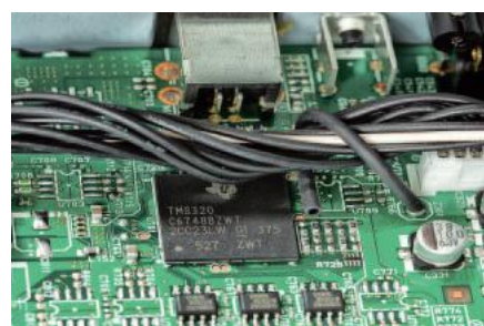
Procesor sygnałowy Texas Instruments obsługuje sygnały z wejść cyfrowych.
