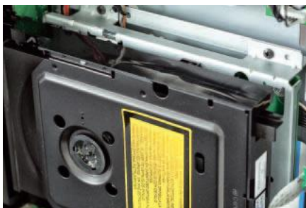
Jeden z głównych wyróżników nowego modelu odtwarzacza – tłumienie drgań w instalacji napędu.
