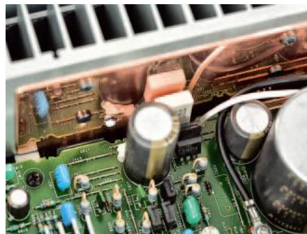
Miedziane płytki na radiatorach wzmacniają i ekranują konstrukcję, tranzystory mocy (jedna para na kanał) umieszczone w szczelinie pod płytką drukowaną.
