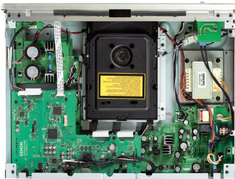
Odtwarzacz ma „piętrową” konstrukcję z odseparowanymi sekcjami napędu, zasilacza, układów cyfrowych i analogowych.
