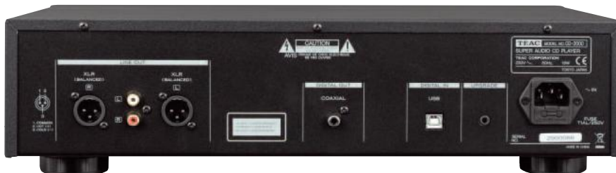
Wyjścia analogowe odtwarzacza pojawiają się w dwóch kompletach – RCA i XLR.
