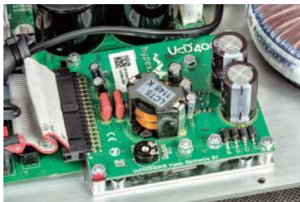
Końcówki mocy to dwa niezależne moduły dostarczone przez holenderskiego Hypexa.
