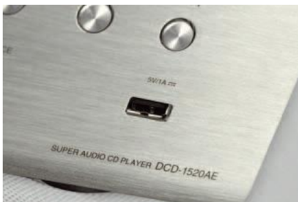
USB z przodu (z tyłu jest drugie) służy do podłączenia sprzętu przenośnego.
