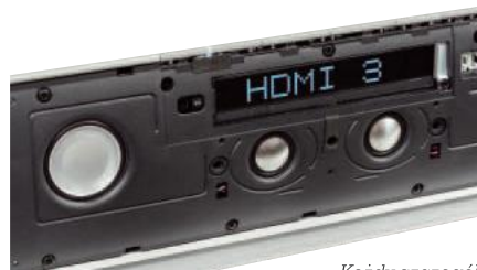
Każdy szczegół, widoczny czy niewidoczny jest dopracowany. Dziesięć przetworników w jednej belce to też niecodzienny widok. Wyświetlacz widać przez tkaninę maskownicę.
