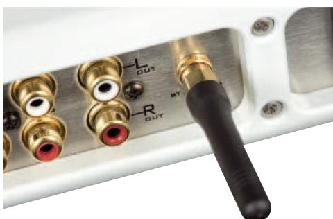
Moduł Bluetooth uzupełniono zewnętrzną antenką, co jest konieczne wobec metalowej obudowy wzmacniacza.
