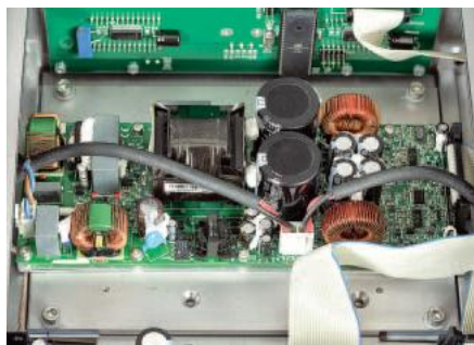
Końcówki mocy zmontowano na jednej płycie, tranzystory przełączające przykręcono do dolnej ścianki poprzez grubą płytę dystansującą.
