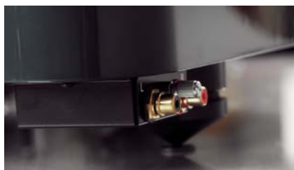
Sygnal na zewnątrz wyprowadza gniazdo RCA któremu towarzyszy uziemienie.
