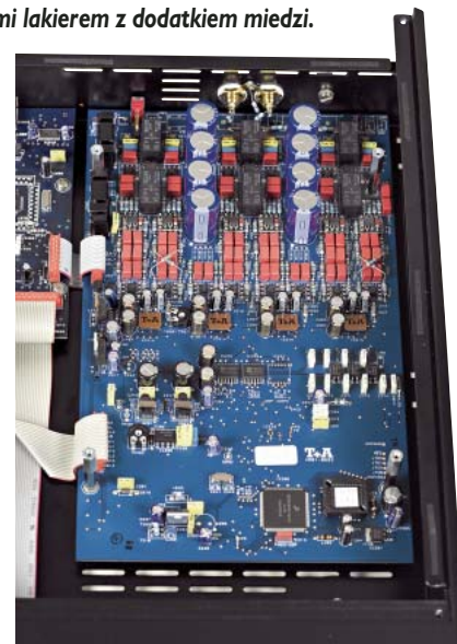
Pod ekranem kryje się piękna, rozbudowana sekcja cyfrowa i analogowa – cztery stereofoniczne przetworniki D/A zakryto małymi, miedzianymi ekranami/radiatorami.
