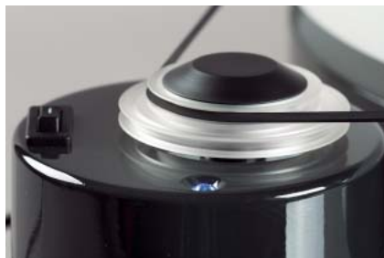
Na osi silnika zamontowano winylowy krążek. Przenosząc pasek na jego dolną część zmieniamy prędkość obrotową z 33, 1/3 na 45 rpm.
