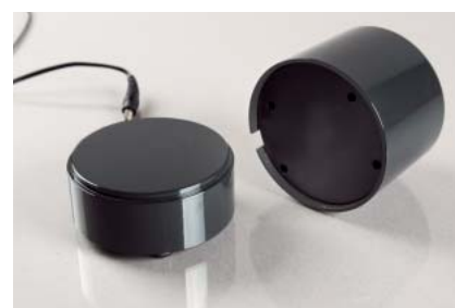
W górnej części obudowy znalazł się silnik, dolna służy jako jego obciążenie.
