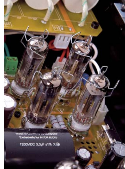
Lampowy mostek prostowniczy złożony z czterech diod.
