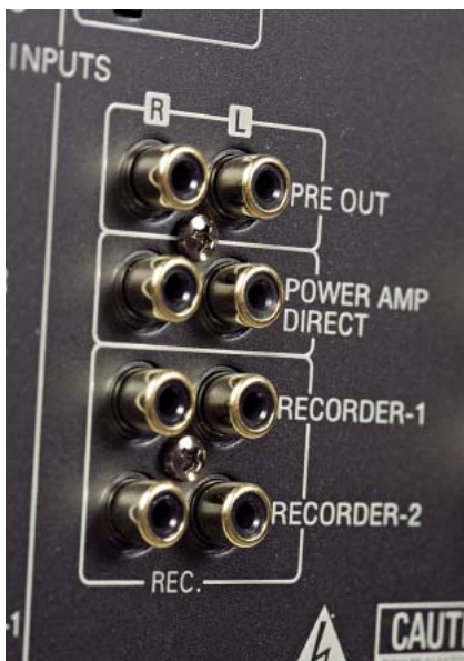
Do dyspozycji mamy dwa wyjścia o stałym poziomie, a także wyjście z poziomem regulowanym (z przedwzmacniacza) oraz na końcówkę mocy - szczególnie przydatne w systemach kina domowego.
