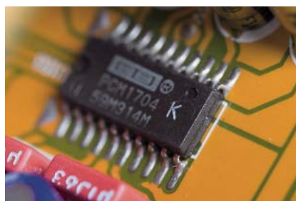
Cztery przetworniki Burr-Browna PCM1704 w specyfikacji K.
