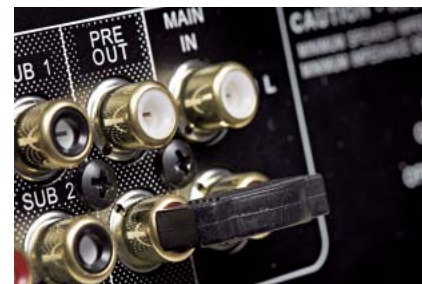
Przedwzmacniacz z końcówką połączono małymi zworami. To trochę archaiczne rozwiązanie jest wciąż stosowane, również w drogich urządzeniach.
