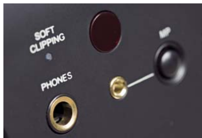
Sygnal do gniazda słuchawkowego pobierany jest z wyjść głośnikowych.
