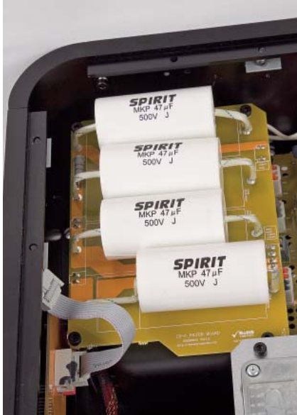
Kondensatory polipropylenowe w zasilaczu napięcia anodowego lamp wyjściowych.
