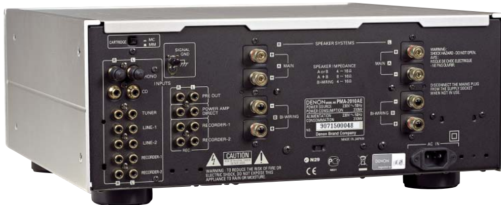
Wyposażenie w przyłączy jest przebogate – podwójne zaciski głośnikowe, wszystkie znane opcje wejść i wyjść RCA. Oczywiście stereo...
