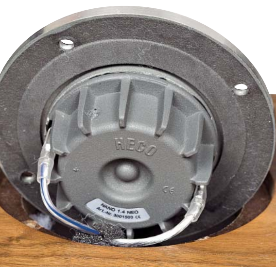
„Nano-Neo” - w odlewanej puszcze wysokotonowego zamknięto magnes neodymowy; membranę pokryto nanocząsteczkami.
