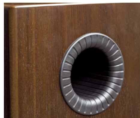
Otwór bas-refleks w górnej części tylnej ścianki nie obsługuje głośnika średniotonowego, ale jest wyprowadzony, podobnie jak otwór na przedniej ściance, ze wspólnej komory głośników niskotonowych.
