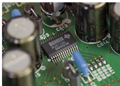
Serce jednej z kilku płytek audio - przetworniki Burr Browna.
