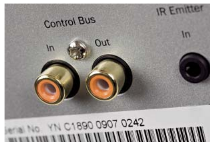
To rzecz w niedrogich systemach rzadka – łącząca do sterowania systemowego, a także dla zewnętrznego czujnika podczerwieni.
