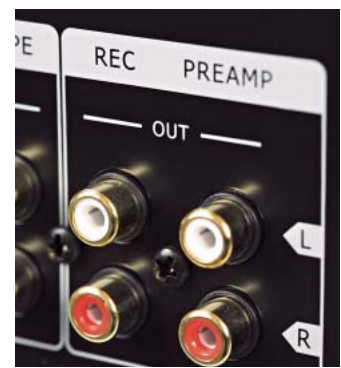
Wzmacniacz Music Halla nie ma „systemowych” fajerwerków, ale jest niezłe wyposażony: jest stereofoniczne wyjście z przedwzmacniacza, i wyjście do nagrywania ze stałym poziomem.
