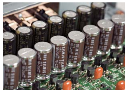
Kondensatory Silmic z najwyższej, dedykowanej urządzeniom audio, rodziny Elny.
