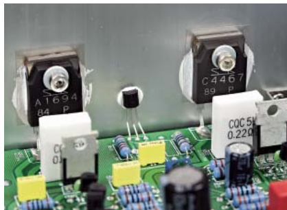
Końcówki mocy zbudowane są wyłącznie przy użyciu tranzystorów. Na końcu mamy po jednej parze bipolarnych tranzystorów Sanken'a 2SA1964+2SC4467, pracujących w push-pullu.
