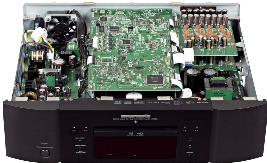
Układy rozdzielono pomiędzy drukowane płytki, utrzymując ład i porządek schludnych połączeń taśmami lub zworami.
