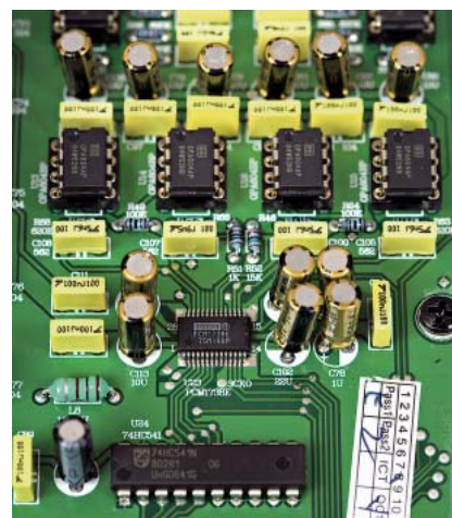
Ładnie i niedrogo: przetwornik Burr-Browna PCM1738, konwersja I/U też na scalakach tej firmy, podobnie jak wzmocnienie i buforowanie wyjścia.
