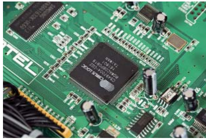
Dekoder surround to procesor DSP firmy Cirrus Logic...
