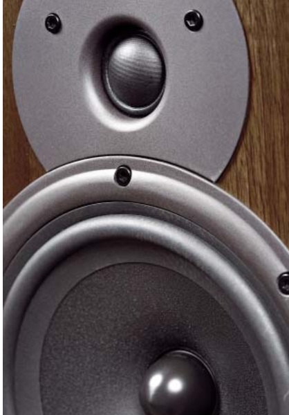
Front tweetera ścięto, by zbliżyć do niego głośnik niskośredniotonowy.
