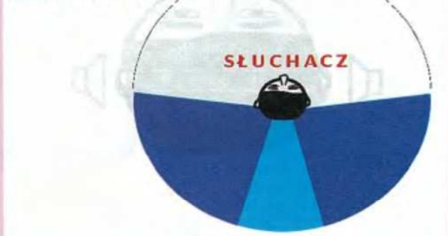
8. Trzy strefy odbierania dźwięków charakteryzujące się różnym stopniem dokładności lokalizacji. W tzw. martwej strefie występują pomyłki w rozróżnieniu tył-przód.
