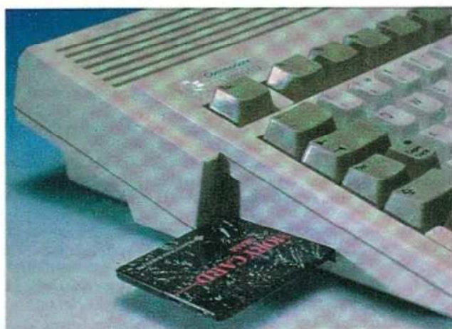
Slot PCMCIA Interfejs w A 600 i A 1200 odpowiada standardowi "PCMCIA PC Card Standard" 2.0.
